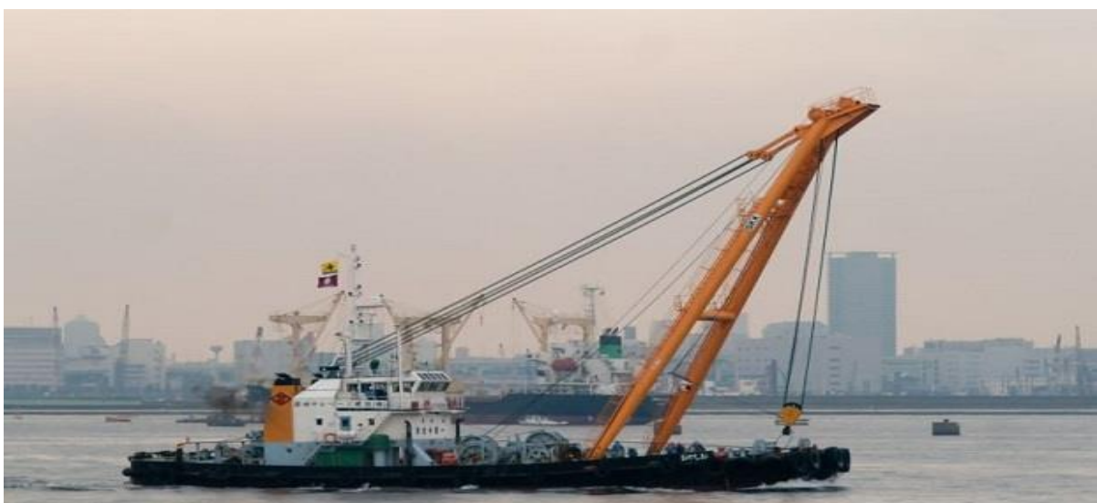
Πλωτός γερανός (Floating Derrick) [1]
