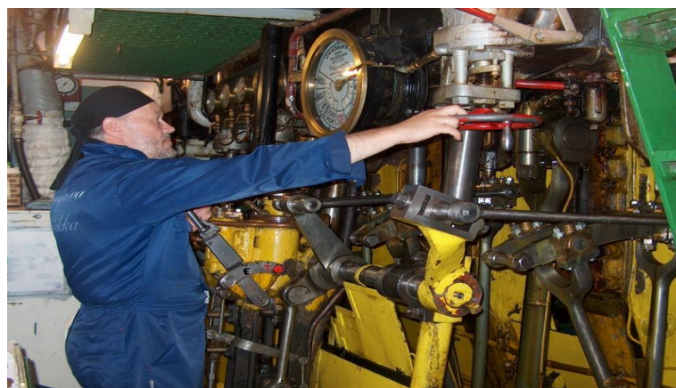
SS Ukkorekka: ατμομηχανή τριών σταδίων
