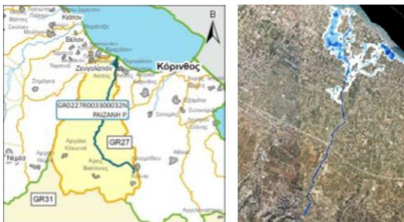
Εικόνα 29: Λεκάνη απορροής του ρ. Ραϊζάνη και σχηματική απεικόνιση της έκτασης μιας πιθανής πλημμύρας με περίοδο επαναφοράς T=100 ετών
