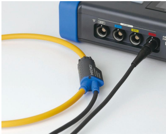
Εικόνα 13 Τοποθετημένος ακροδέκτης στο HIOKI PW3198.
