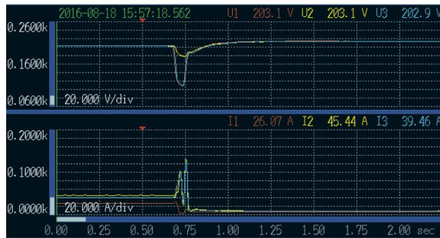
Εικόνα7 Στιγμιότυπο από την οθόνη του καταγραφικού κατά την μέτρηση, όπου στο άνω μέρος φαίνεται το γράφημα της ενεργού τάσης και στο κάτω της ενεργού ηλεκτρικής έντασης.
