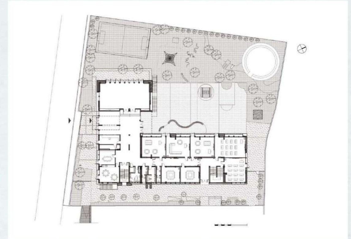
Εικόνα 31: Κάτοψη ισογείου του σχολείου στο Μαρούσι. (πηγή: 3)
