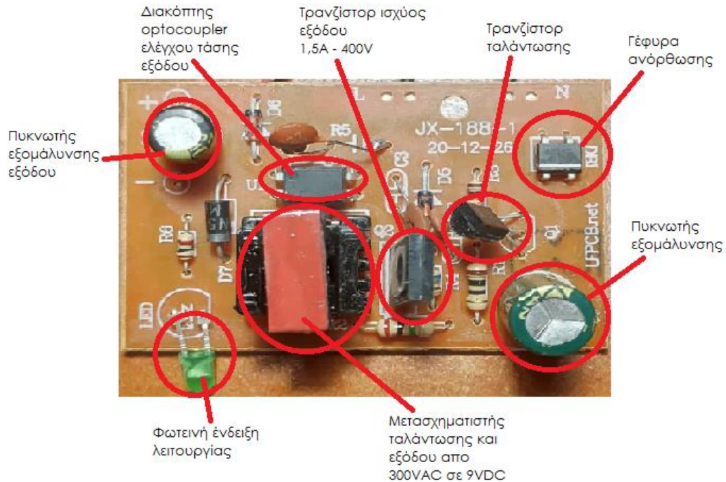
Εικόνα 2.44: Κύκλωμα και επεξήγηση εξαρτημάτων τροφοδοτικού μονής εξόδου 9W των 9V – 1A, μοντέλου QN-0305 [74].
