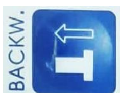
Εικόνα 1.11: Εντολή οδήγησης τράπεζας όπισθεν. Με την βοήθεια ενός πέμπτου τροχού, ο οποίος στις περισσότερες χειρουργικές τράπεζες βρίσκεται στο κέντρο της βάσης τους, όπου είναι συνδεδεμένος με ένα μοτέρ, ωθεί την τράπεζα προς τα πίσω. Η λειτουργία αυτή είναι επιτρεπτή μόνο για την μεταφορά του κρεβατιού χωρίς ασθενή επάνω του.
