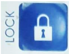
Εικόνα 1.7: Εντολή κλειδώματος θέσης χειρουργικής τράπεζας στον χώρο. Η διαδικασία πραγματοποιείται με το κατέβασμα στύλων – συριγμάτων όπου σηκώνουν την χειρουργική τράπεζα με αποτέλεσμα οι τροχοί να είναι στον αέρα σταθεροποιώντας την τράπεζα.
