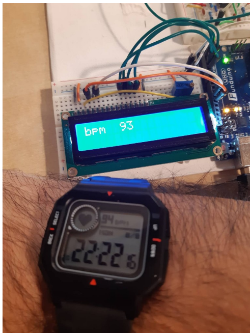
Εικόνα 4.3α Σύγκριση της κατασκευής με activity tracker Amazfit Neo.
