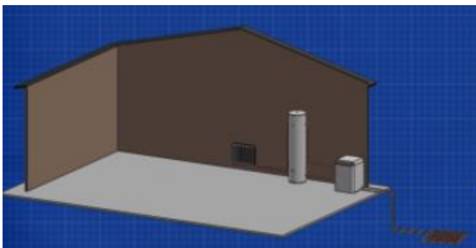
Εικόνα 4-4 Σχηματική απεικόνιση αντλίας θερμότητας νερού-νερού (theengineeringmindset, 2018)
