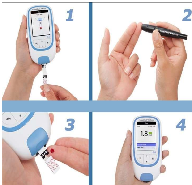
Εικόνα 1-6 Σύστημα POCT μέτρησης INR CoaguCheck® INrange της Roche Diagnostics [17]
