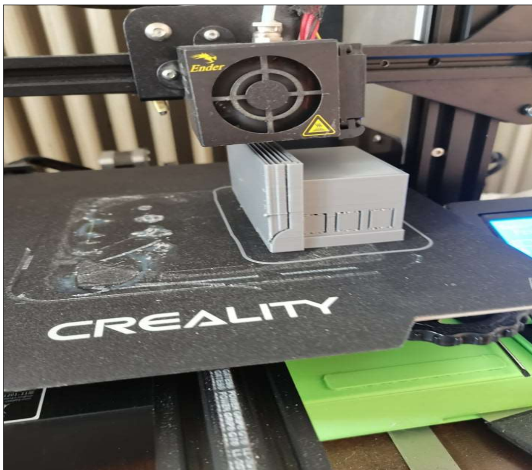
Εικόνα 3-4 Η 3-D εκτύπωση του σχεδίου, με τον Ender V.2 της Creality ©.
