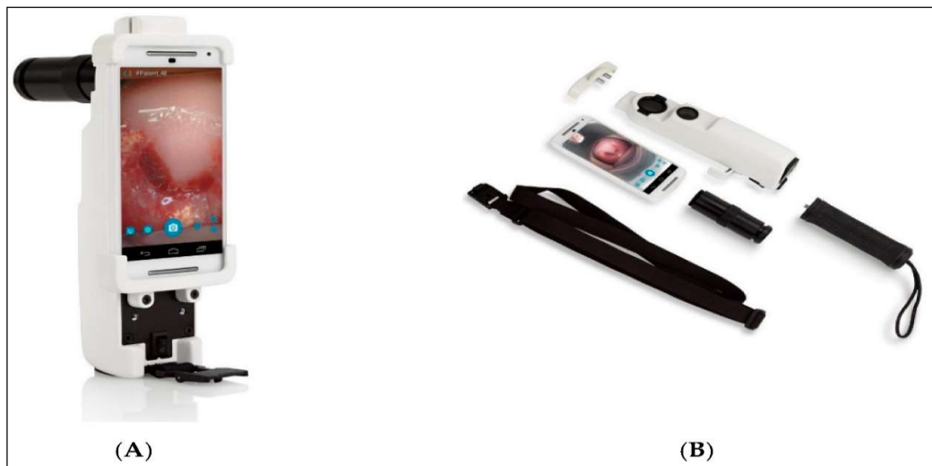
Εικόνα 1-11 (A) Φορητό κολποσκόπιο Eνα® με βάση το smartphone, (B) διατάξεις που το απαρτίζουν [23]
