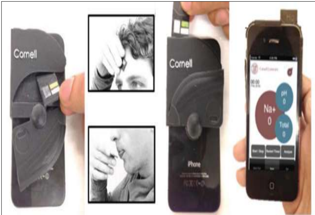
Εικόνα 1-20 In-Vitro smartphone-based διάταξη ηλεκτροχημειοφωταύγειας σε ιδρώτα[29]
