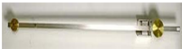
Εικόνα 2.13: Αντιστρέψιμο Εκκρεμές του Henry Kater (Α.Δεληκαράογλου 2003).
