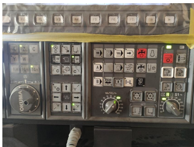
Εικόνα 5.3: Έλεγχος μύλου και μεταβολή προώσεων και ταχυτήτων κοπής.
