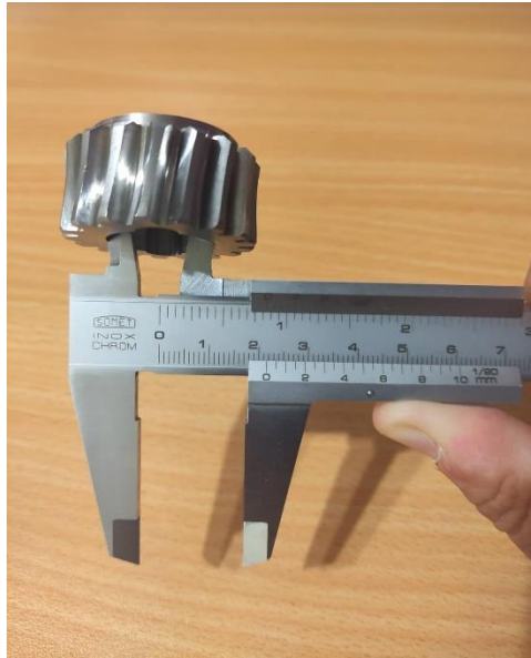
Εικόνα 3.7: Μέτρηση διαμέτρου εσωτερικής οπής οδοντωτού τροχού.
