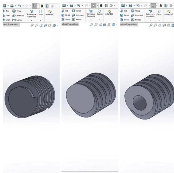
Εικόνα 3.24: Διόρθωση σπειρώματος και σχεδιασμός σπής στον ατέρμονα.
