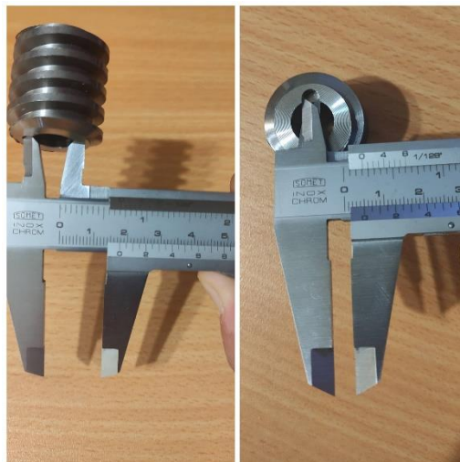
Εικόνα 3.4: Μέτρηση διαστάσεων κενού για αξονάκι.
