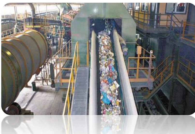
Εικόνα 10 - Στάδιο μηχανικής ανακύκλωσης
