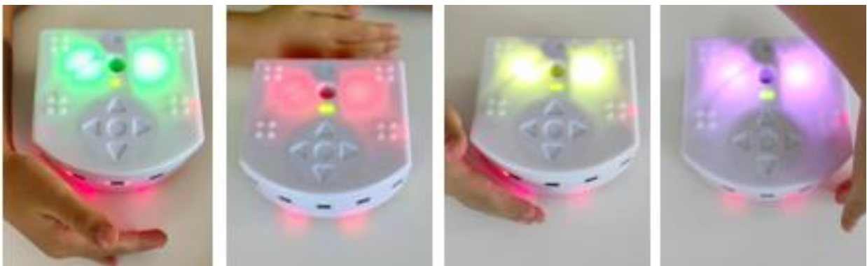
Εικόνα 7 Άναμμα κεντρικού φωτισμού Thymio σε χρωματικό κώδικα με άγγιγμα των αισθητήρων
