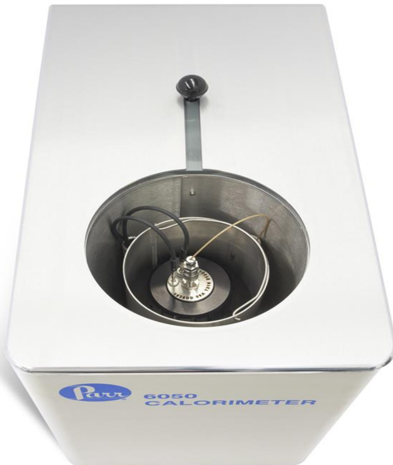
Σχήμα 3.5: Μέρη θερμιδόμετρου Parr 6050.
