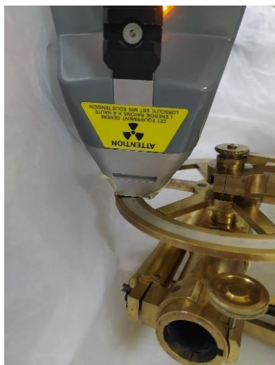
Εικόνα 104 Ανάλυση στον βερνιέρο του κατακόρυφου κύκλου. ©Γερμανικό Αρχαιολογικό Ινστιτούτο, Εργαστήριο Συντήρησης Μεταλλικών Αντικειμένων, Πα.Δ.Α. (Ε. Αναμουρλίδου, Α. Σαμπάνης).
