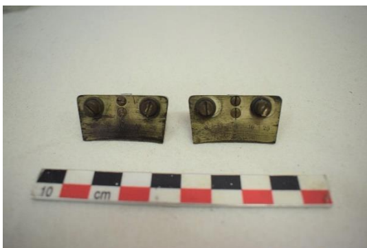
Εικόνα 205 Εμπρόσθια όψη βερνιέρων κύκλου, πριν τη συντήρηση (Διόπτρα μετροτράπεζας). ©Γερμανικό Αρχαιολογικό Ινστιτούτο, Εργαστήριο Συντήρησης Μεταλλικών Αντικειμένων, Πα.Δ.Α. (Ε. Αναμουρλίδου, Α. Σαμπάνης).
