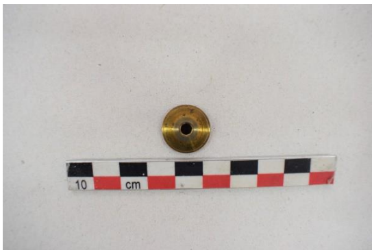
Εικόνα 240 Οπίσθια όψη κοχλία τηλεσκοπίου, πριν τη συντήρηση (Μικρός χωροβάτης). ©Γερμανικό Αρχαιολογικό Ινστιτούτο, Εργαστήριο Συντήρησης Μεταλλικών Αντικειμένων, Πα.Δ.Α. (Ε. Αναμουρλίδου, Α. Σαμπάνης).
