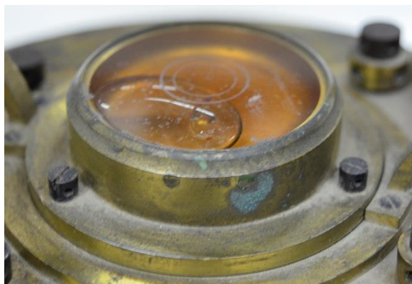
Εικόνα 110 Γαλαζοπράσινα προϊόντα διάβρωσης στη σφαιρική αεροστάθμη του "κίτρινου θεοδόλιχου". ©Γερμανικό Αρχαιολογικό Ινστιτούτο, Εργαστήριο Συντήρησης Μεταλλικών Αντικειμένων, Πα.Δ.Α. (Ε. Αναμουρλίδου, Α. Σαμπάνης).
