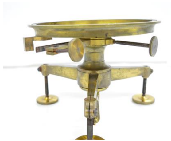
Εικόνα 27 Η Γερμανική τροποποίηση στο Θεοδόλιχο. Ο κοχλίας σύσφιξης κάθετος στον συσφιγκτήρα και το μεταλλικό έλασμα πίσω από τον ανασταλτικό κοχλία. ©Γερμανικό Αρχαιολογικό Ινστιτούτο, Εργαστήριο Συντήρησης Μεταλλικών Αντικειμένων, Πα.Δ.Α. (Ε. Αναμουρλίδου, Α. Σαμπάνης)
