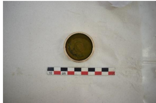
Εικόνα 218 Εμπρόσθια όψη της σφαιρικής αεροστάθμης του κανόνα, μετά τη συντήρηση (Διόπτρα μετροτράπεζας). ©Γερμανικό Αρχαιολογικό Ινστιτούτο, Εργαστήριο Συντήρησης Μεταλλικών Αντικειμένων, Πα.Δ.Α. (Ε. Αναμουρλίδου, Α. Σαμπάνης).
