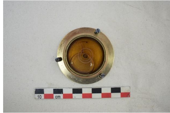
Εικόνα 299 Η εμπρόσθια όψη της σφαιρικής αεροστάθμης, μετά τη συντήρηση (Θεοδόλιχος). ©Γερμανικό Αρχαιολογικό Ινστιτούτο, Εργαστήριο Συντήρησης Μεταλλικών Αντικειμένων, Πα.Δ.Α. (Ε. Αναμουρλίδου, Α. Σαμπάνης).
