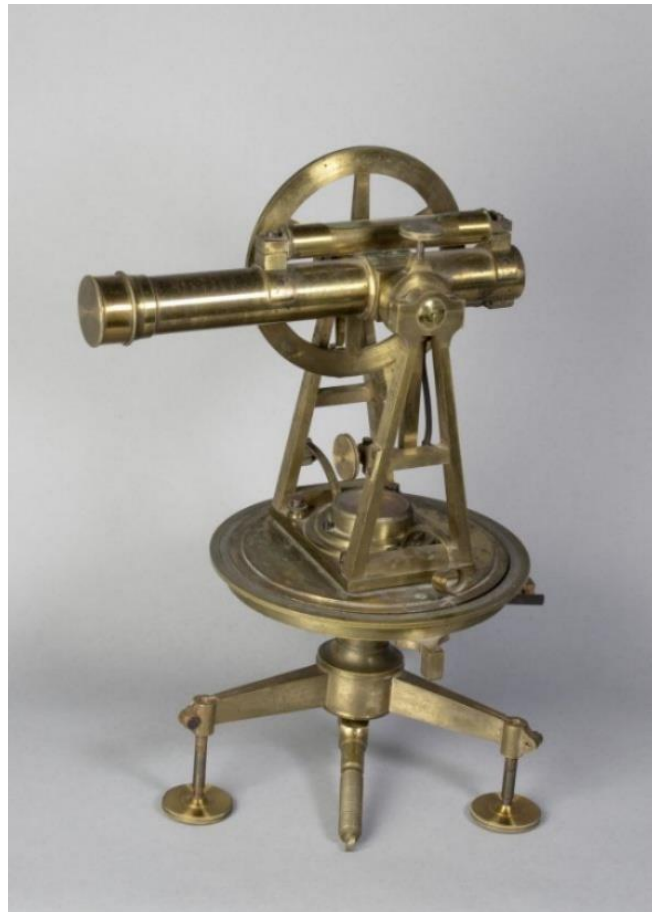
Εικόνα 13 Θεοδόλιχος. (©Αρχείο Γ.Α.Ι., D-DAI-ATH-2019-00019)
