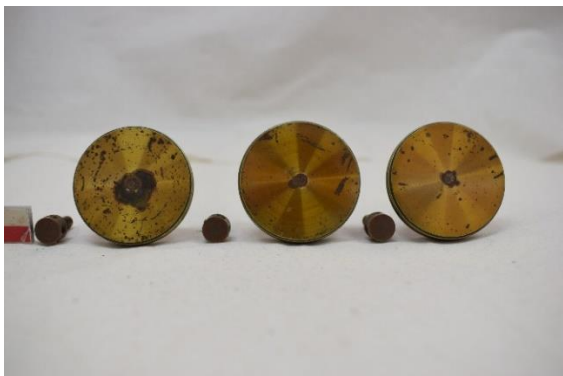
Εικόνα 157 Οι κεφαλές των κοχλιών του τρικοχλίου, πριν τη συντήρηση (Μαύρος χωροβάτης). ©Γερμανικό Αρχαιολογικό Ινστιτούτο, Εργαστήριο Συντήρησης Μεταλλικών Αντικειμένων, Πα.Δ.Α. (Ε. Αναμουρλίδου, Α. Σαμπάνης).
