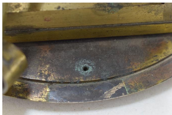
Εικόνα 111 Γαλαζοπράσινα προϊόντα διάβρωσης στο δείκτη του "κίτρινου θεοδόλιχου". ©Γερμανικό Αρχαιολογικό Ινστιτούτο, Εργαστήριο Συντήρησης Μεταλλικών Αντικειμένων, Πα.Δ.Α. (Ε. Αναμουρλίδου, Α. Σαμπάνης).
