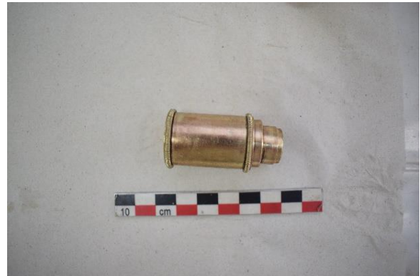
Εικόνα 293 Ο προσοφθάλμιος φακός του θεοδόλιχου, μετά τη συντήρηση (Θεοδόλιχος). ©Γερμανικό Αρχαιολογικό Ινστιτούτο, Εργαστήριο Συντήρησης Μεταλλικών Αντικειμένων, Πα.Δ.Α. (Ε. Αναμουρλίδου, Α. Σαμπάνης).
