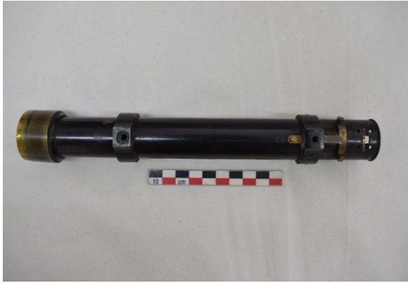
Εικόνα 147 Το τηλεσκόπιο του χωροβάτη, πριν τη συντήρηση (Μαύρος χωροβάτης). ©Γερμανικό Αρχαιολογικό Ινστιτούτο, Εργαστήριο Συντήρησης Μεταλλικών Αντικειμένων, Πα.Δ.Α. (Ε. Αναμουρλίδου, Α. Σαμπάνης).
