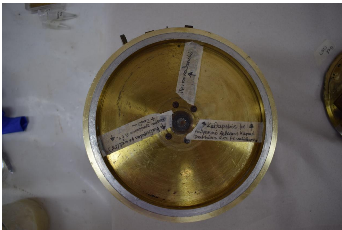
Εικόνα 127 Το άνω μέρος του οριζόντιου κύκλου μετά τις δοκιμές καθαρισμού. ©Γερμανικό Αρχαιολογικό Ινστιτούτο, Εργαστήριο Συντήρησης Μεταλλικών Αντικειμένων, Πα.Δ.Α. (Ε. Αναμουρλίδου, Α. Σαμπάνης).
