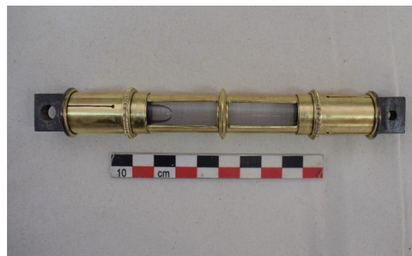
Εικόνα 188 Άνω όψη σωληνωτής αεροστάθμης τηλεσκοπίου, μετά τη συντήρηση (Διόπτρα μετροτράπεζας). ©Γερμανικό Αρχαιολογικό Ινστιτούτο, Εργαστήριο Συντήρησης Μεταλλικών Αντικειμένων, Πα.Δ.Α. (Ε. Αναμουρλίδου, Α. Σαμπάνης).
