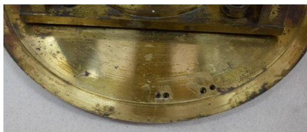
Εικόνα 138 Η περιοχή του δείκτη, στην οποία διατηρείται βερνίκι μετά την εναπόθεση των πηκτών. ©Γερμανικό Αρχαιολογικό Ινστιτούτο, Εργαστήριο Συντήρησης Μεταλλικών Αντικειμένων, Πα.Δ.Α. (Ε. Αναμουρλίδου, Α. Σαμπάνης).
