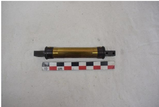
Εικόνα 179 Κάτω όψη σωληνωτής αεροστάθμης βραχιόνων, πριν τη συντήρηση (Διόπτρα μετροτράπεζας). ©Γερμανικό Αρχαιολογικό Ινστιτούτο, Εργαστήριο Συντήρησης Μεταλλικών Αντικειμένων, Πα.Δ.Α. (Ε. Αναμουρλίδου, Α. Σαμπάνης).
