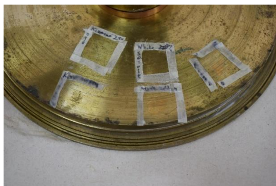
Εικόνα 124 Περιοχές δοκιμών κάτω από τον οριζόντιο κύκλο. Μετά τον καθαρισμό. ©Γερμανικό Αρχαιολογικό Ινστιτούτο, Εργαστήριο Συντήρησης Μεταλλικών Αντικειμένων, Πα.Δ.Α. (Ε. Αναμουρλίδου, Α. Σαμπάνης).
