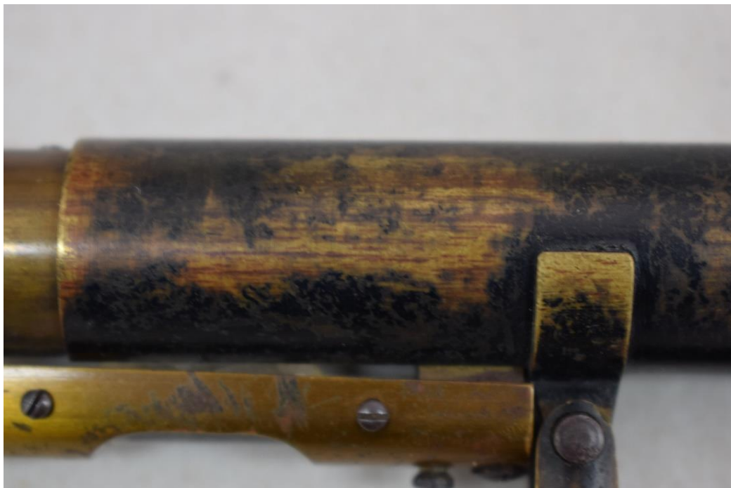
Εικόνα 88 Η περιοχή θερνικιού, που έχει αφαιρεθεί από τη χρήση το μαύρο επικαλυπτικό και έχουν αποκαλυφθεί τα "νερά ξύλου". ©Γερμανικό Αρχαιολογικό Ινστιτούτο, Εργαστήριο Συντήρησης Μεταλλικών Αντικειμένων, Πα.Δ.Α. (Ε. Αναμουρλίδου, Α. Σαμπάνης).
