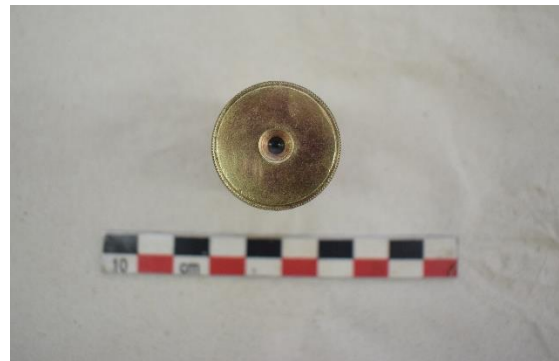
Εικόνα 297 Η εμπρόσθια όψη του προσοφθάλμιου φακού, μετά τη συντήρηση (Θεοδόλιχος). ©Γερμανικό Αρχαιολογικό Ινστιτούτο, Εργαστήριο Συντήρησης Μεταλλικών Αντικειμένων, Πα.Δ.Α. (Ε. Αναμουρλίδου, Α. Σαμπάνης).
