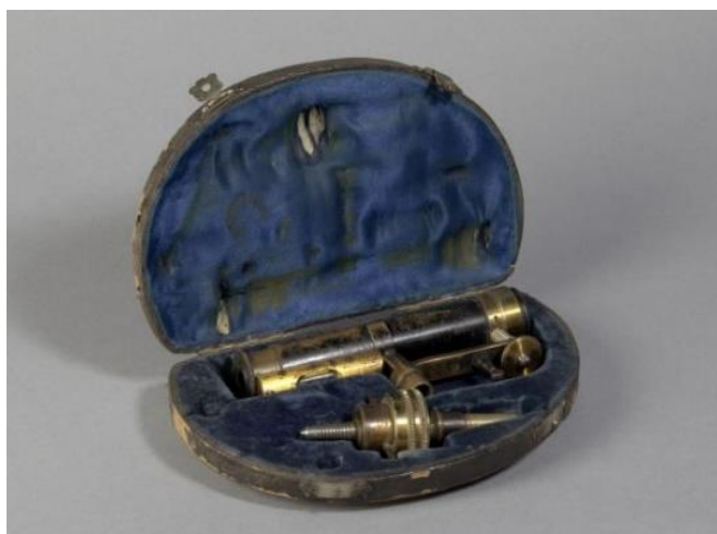
Εικόνα 16 Μικρός χωροβάτης μέσα στην θήκη του. (©Αρχείο Γ.Α.Ι., D-DAI-ATH-2019-00014)
