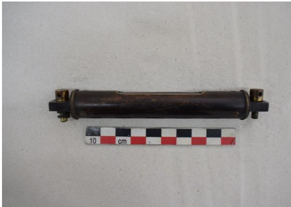
Εικόνα 171 Πλάγια όψη της σωληνωτής αεροστάθμης, πριν τη συντήρηση (Μαύρος χωροβάτης). ©Γερμανικό Αρχαιολογικό Ινστιτούτο, Εργαστήριο Συντήρησης Μεταλλικών Αντικειμένων, Πα.Δ.Α. (Ε. Αναμουρλίδου, Α. Σαμπάνης).
