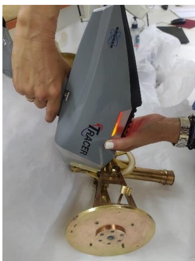
Εικόνα 105 Ανάλυση στον βερνιέρο του κατακόρυφου κύκλου. ©Γερμανικό Αρχαιολογικό Ινστιτούτο, Εργαστήριο Συντήρησης Μεταλλικών Αντικειμένων, Πα.Δ.Α. (Ε. Αναμουρλίδου, Α. Σαμπάνης).
