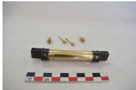
Εικόνα 180 Κάτω όψη σωληνωτής αεροστάθμης βραχιόνων, πριν τη συντήρηση (Διόπτρα μετροτράπεζας). ©Γερμανικό Αρχαιολογικό Ινστιτούτο, Εργαστήριο Συντήρησης Μεταλλικών Αντικειμένων, Πα.Δ.Α. (Ε. Αναμουρλίδου, Α. Σαμπάνης).
