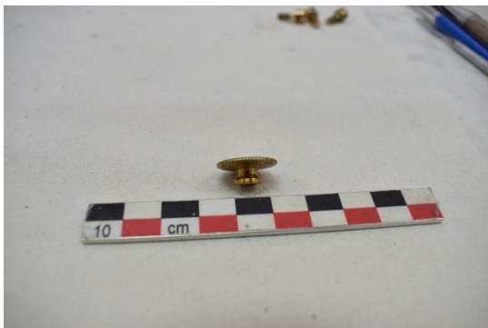
Εικόνα 242 Πλάγια όψη του κοχλία τηλεσκοπίου, πριν τη συντήρηση (Μικρός χωροβάτης). ©Γερμανικό Αρχαιολογικό Ινστιτούτο, Εργαστήριο Συντήρησης Μεταλλικών Αντικειμένων, Πα.Δ.Α. (Ε. Αναμουρλίδου, Α. Σαμπάνης).
