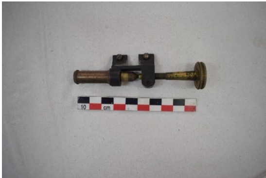
Εικόνα 195 Εξαρτήματα ανασταλτικού κοχλία, πριν τη συντήρηση (Διόπτρα μετροτράπεζας). ©Γερμανικό Αρχαιολογικό Ινστιτούτο, Εργαστήριο Συντήρησης Μεταλλικών Αντικειμένων, Πα.Δ.Α. (Ε. Αναμουρλίδου, Α. Σαμπάνης).
