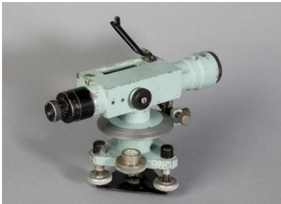
Εικόνα 5 Χωροβάτης. (©Αρχείο Γ.Α.Ι., D-DAI-ATH-2019-00003)
