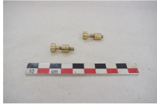
Εικόνα 225 Κοχλίες του κατακόρυφου κύκλου, μετά τη συντήρηση (Διόπτρα μετροτράπεζας). ©Γερμανικό Αρχαιολογικό Ινστιτούτο, Εργαστήριο Συντήρησης Μεταλλικών Αντικειμένων, Πα.Δ.Α. (Ε. Αναμουρλίδου, Α. Σαμπάνης).
