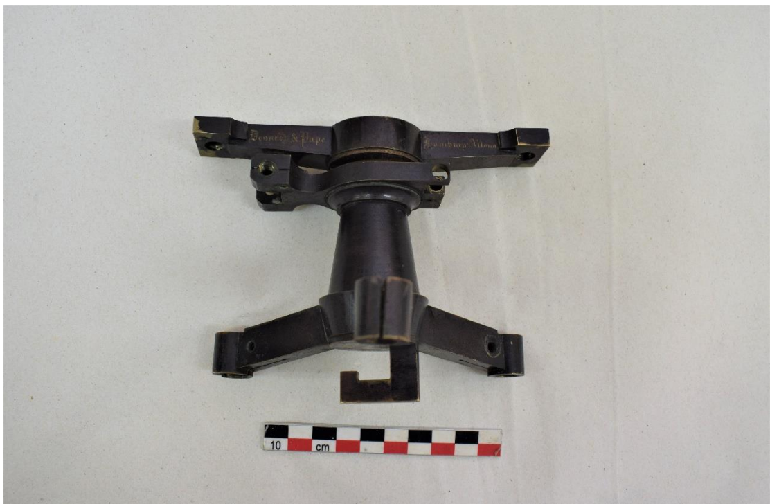
Εικόνα 89 Η βάση του μαύρου χωροβάτη. Το φάσμα πάρθηκε από το πάνω κεντρικό κυκλικό μέρος. ©Γερμανικό Αρχαιολογικό Ινστιτούτο, Εργαστήριο Συντήρησης Μεταλλικών Αντικειμένων, Πα.Δ.Α. (Ε. Αναμουρλίδου, Α. Σαμπάνης).
