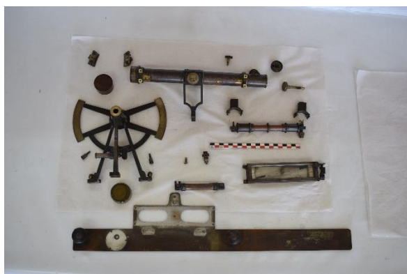
Εικόνα 145 Η διόπτρα μετροτράπεζας αποσυναρμολογημένη. ©Γερμανικό Αρχαιολογικό Ινστιτούτο, Εργαστήριο Συντήρησης Μεταλλικών Αντικειμένων, Πα.Δ.Α. (Ε. Αναμουρλίδου, Α. Σαμπάνης).
