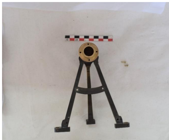
Εικόνα 214 Οι βραχίονες άντυγα της διόπτρας, μετά τη συντήρηση (Διόπτρα μετροτράπεζας). ©Γερμανικό Αρχαιολογικό Ινστιτούτο, Εργαστήριο Συντήρησης Μεταλλικών Αντικειμένων, Πα.Δ.Α. (Ε. Αναμουρλίδου, Α. Σαμπάνης).
