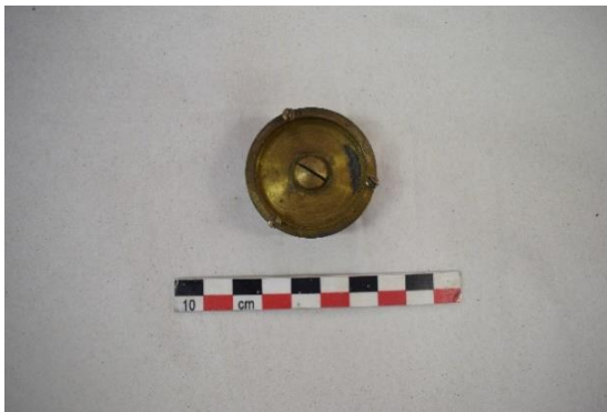
Εικόνα 219 Οπίσθια όψη της σφαιρικής αεροστάθμης του κανόνα, πριν τη συντήρηση (Διόπτρα μετροτράπεζας). ©Γερμανικό Αρχαιολογικό Ινστιτούτο, Εργαστήριο Συντήρησης Μεταλλικών Αντικειμένων, Πα.Δ.Α. (Ε. Αναμουρλίδου, Α. Σαμπάνης).
