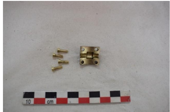
Εικόνα 184 Κάτω όψη του κοχλία εστίασης, μετά τη συντήρηση (Διόπτρα μετροτράπεζας). ©Γερμανικό Αρχαιολογικό Ινστιτούτο, Εργαστήριο Συντήρησης Μεταλλικών Αντικειμένων, Πα.Δ.Α. (Ε. Αναμουρλίδου, Α. Σαμπάνης).
