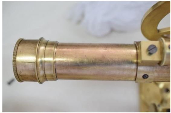
Εικόνα 267 Το τηλεσκόπιο του θεοδόλιχου, μετά τη συντήρηση (Θεοδόλιχος). ©Γερμανικό Αρχαιολογικό Ινστιτούτο, Εργαστήριο Συντήρησης Μεταλλικών Αντικειμένων, Πα.Δ.Α. (Ε. Αναμουρλίδου, Α. Σαμπάνης).
