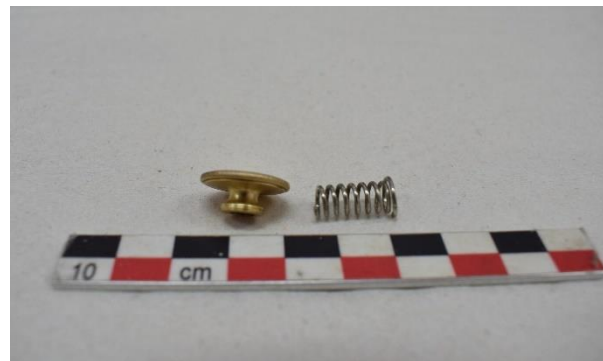
Εικόνα 243 Πλάγια όψη του κοχλία τηλεσκοπίου, μετά τη συντήρηση (Μικρός χωροβάτης). ©Γερμανικό Αρχαιολογικό Ινστιτούτο, Εργαστήριο Συντήρησης Μεταλλικών Αντικειμένων, Πα.Δ.Α. (Ε. Αναμουρλίδου, Α. Σαμπάνης).
