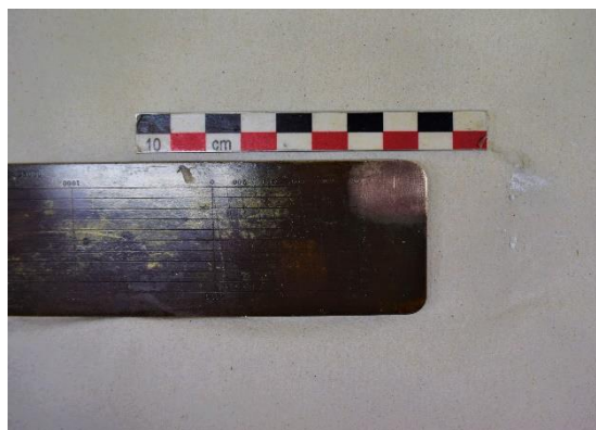
Εικόνα 139 Η ροζ εναπομείναν επιφάνεια μετά τον καθαρισμό με μυρμηκικό οξύ. ©Γερμανικό Αρχαιολογικό Ινστιτούτο, Εργαστήριο Συντήρησης Μεταλλικών Αντικειμένων, Πα.Δ.Α. (Ε. Αναμουρλίδου, Α. Σαμπάνης).
