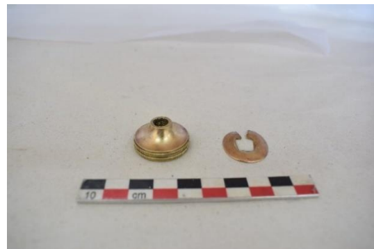
Εικόνα 204 Πώμα κοχλία ατράκτου, μετά τη συντήρηση (Διόπτρα μετροτράπεζας). ©Γερμανικό Αρχαιολογικό Ινστιτούτο, Εργαστήριο Συντήρησης Μεταλλικών Αντικειμένων, Πα.Δ.Α. (Ε. Αναμουρλίδου, Α. Σαμπάνης).
