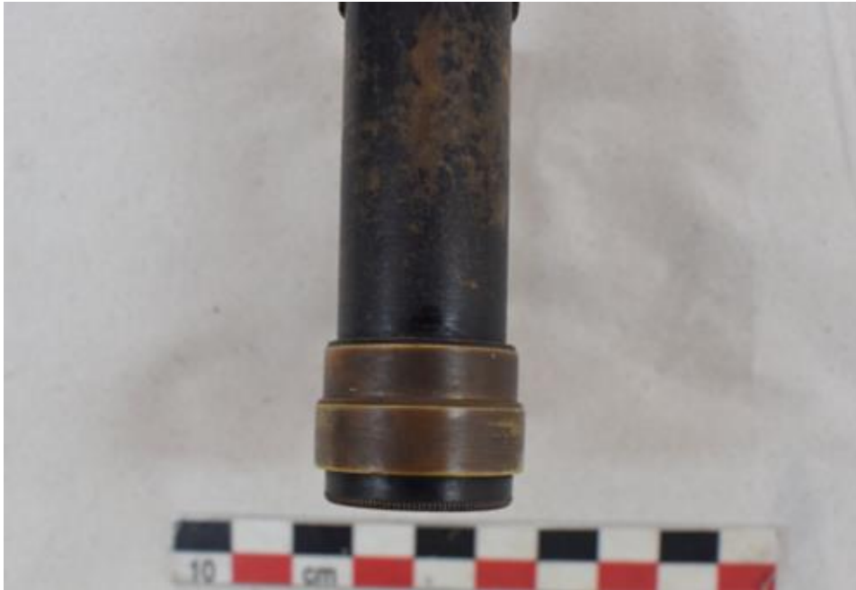
Εικόνα 87 Το μαύρο επικαλυπτικό, στο άνω μέρος του τηλεσκοπίου που διατηρείται υγιές. ©Γερμανικό Αρχαιολογικό Ινστιτούτο, Εργαστήριο Συντήρησης Μεταλλικών Αντικειμένων, Πα.Δ.Α. (Ε. Αναμουρλίδου, Α. Σαμπάνης).
