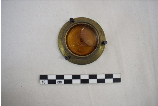
Εικόνα 298 Η εμπρόσθια όψη της σφαιρικής αεροστάθμης, πριν τη συντήρηση (Θεοδόλιχος). ©Γερμανικό Αρχαιολογικό Ινστιτούτο, Εργαστήριο Συντήρησης Μεταλλικών Αντικειμένων, Πα.Δ.Α. (Ε. Αναμουρλίδου, Α. Σαμπάνης).
