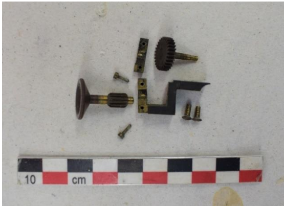
Εικόνα 189 Εξαρτήματα του κοχλία του κλισιμέτρου, πριν τη συντήρηση (Διόπτρα μετροτράπεζας). ©Γερμανικό Αρχαιολογικό Ινστιτούτο, Εργαστήριο Συντήρησης Μεταλλικών Αντικειμένων, Πα.Δ.Α. (Ε. Αναμουρλίδου, Α. Σαμπάνης).
