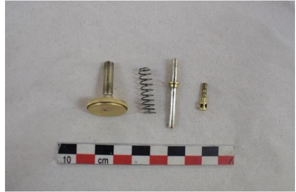
Εικόνα 152 Τα εξαρτήματα του ανασταλτικού κοχλίου, μετά τη συντήρηση (Μαύρος χωροβάτης). ©Γερμανικό Αρχαιολογικό Ινστιτούτο, Εργαστήριο Συντήρησης Μεταλλικών Αντικειμένων, Πα.Δ.Α. (Ε. Αναμουρλίδου, Α. Σαμπάνης).
