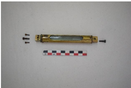
Εικόνα 302 Σωληνωτή αεροστάθμη του τηλεσκοπίου, πριν την συντήρηση (Θεοδόλιχος). ©Γερμανικό Αρχαιολογικό Ινστιτούτο, Εργαστήριο Συντήρησης Μεταλλικών Αντικειμένων, Πα.Δ.Α. (Ε. Αναμουρλίδου, Α. Σαμπάνης).
