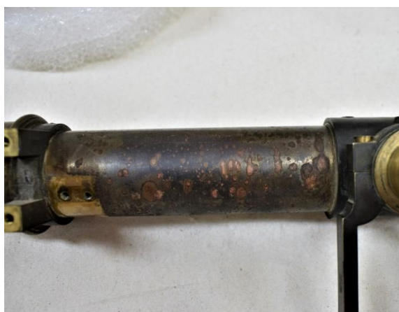
Εικόνα 119 Η οπίσθια όψη του τηλεσκοπίου με τα στίγματα διάβρωσης. ©Γερμανικό Αρχαιολογικό Ινστιτούτο, Εργαστήριο Συντήρησης Μεταλλικών Αντικειμένων, Πα.Δ.Α. (Ε. Αναμουρλίδου, Α. Σαμπάνης).
