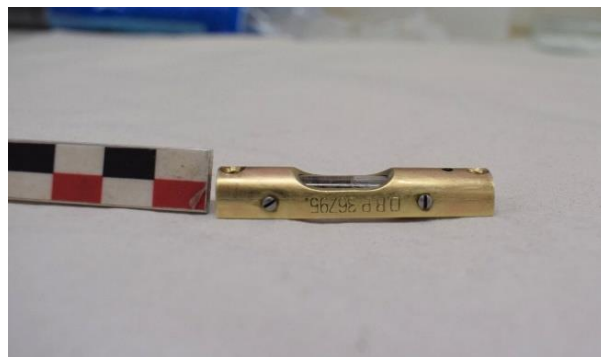
Εικόνα 237 Πλάγια όψη της σωληνωτής αεροστάθμης, μετά τη συντήρηση (Μικρός χωροβάτης). ©Γερμανικό Αρχαιολογικό Ινστιτούτο, Εργαστήριο Συντήρησης Μεταλλικών Αντικειμένων, Πα.Δ.Α. (Ε. Αναμουρλίδου, Α. Σαμπάνης).
