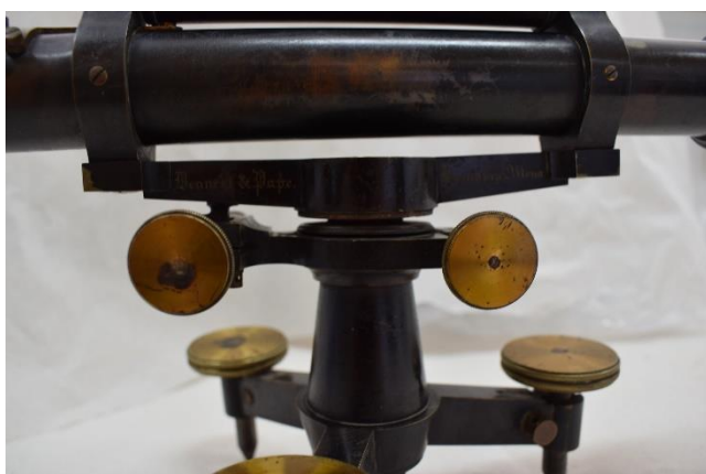
Εικόνα 46 Το επίπεδο έδρασης, με τον ανασταλτικό κοχλία αριστερά και το κοχλία σύσφιξης δεξιά. ©Γερμανικό Αρχαιολογικό Ινστιτούτο, Εργαστήριο Συντήρησης Μεταλλικών Αντικειμένων, Πα.Δ.Α. (Ε. Αναμουρλίδου, Α. Σαμπάνης)
