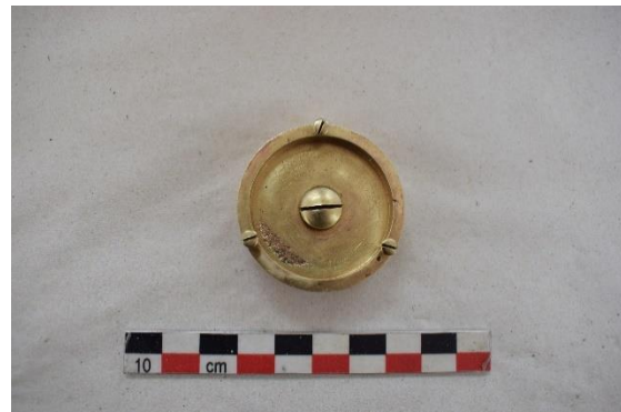
Εικόνα 220 Οπίσθια όψη της σφαιρικής αεροστάθμης του κανόνα, μετά τη συντήρηση (Διόπτρα μετροτράπεζας). ©Γερμανικό Αρχαιολογικό Ινστιτούτο, Εργαστήριο Συντήρησης Μεταλλικών Αντικειμένων, Πα.Δ.Α. (Ε. Αναμουρλίδου, Α. Σαμπάνης).
