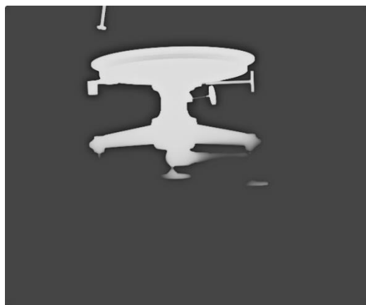
Εικόνα 74 Τα αποτελέσματα της ακτινογράφισης (110 kVp, 100 mAs) της πλάγιας όψης του τρικοχλίου του Θεοδόλιχου.
