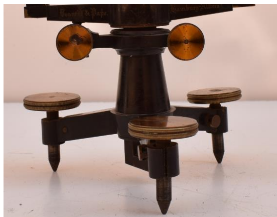
Εικόνα 48 Το κάτω μέρος του μαύρου χωροβάτη στηρίζεται στο τρικόχλιο. © Γερμανικό Αρχαιολογικό Ινστιτούτο, Εργαστήριο Συντήρησης Μεταλλικών Αντικειμένων, Πα.Δ.Α. (Ε. Αναμουρλίδου, Α. Σαμπάνης)
