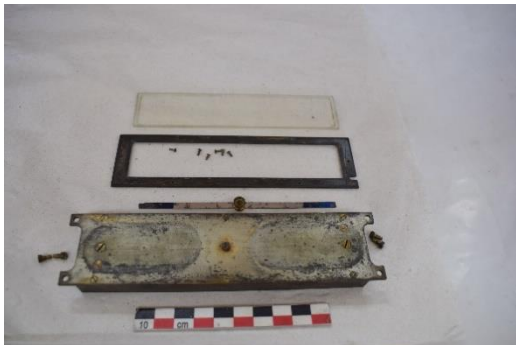
Εικόνα 228 Οπίσθια όψη του κλισιμέτρου, πριν τη συντήρηση (Διόπτρα μετροτράπεζας). ©Γερμανικό Αρχαιολογικό Ινστιτούτο, Εργαστήριο Συντήρησης Μεταλλικών Αντικειμένων, Πα.Δ.Α. (Ε. Αναμουρλίδου, Α. Σαμπάνης).
