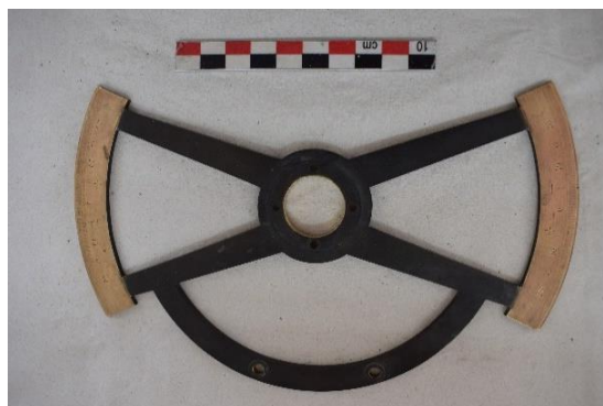
Εικόνα 216 Ο κατακόρυφος κύκλος, μετά τη συντήρηση (Διόπτρα μετροτράπεζας). ©Γερμανικό Αρχαιολογικό Ινστιτούτο, Εργαστήριο Συντήρησης Μεταλλικών Αντικειμένων, Πα.Δ.Α. (Ε. Αναμουρλίδου, Α. Σαμπάνης).
