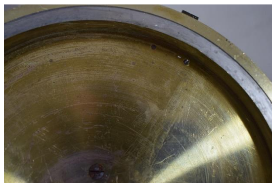
Εικόνα 128 Η μειωμένη περιοχή του βερνικιού σε σύγκριση με την πλήρως καθαρισμένη. ©Γερμανικό Αρχαιολογικό Ινστιτούτο, Εργαστήριο Συντήρησης Μεταλλικών Αντικειμένων, Πα.Δ.Α. (Ε. Αναμουρλίδου, Α. Σαμπάνης).
