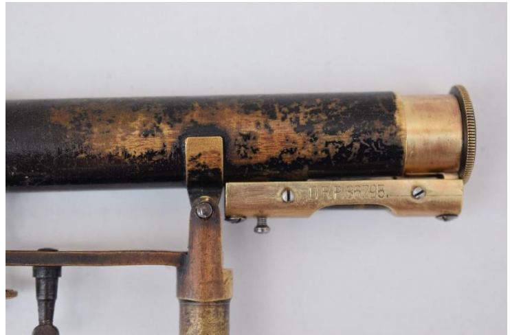
Εικόνα 117 Η απώλεια της εξωτερικής βαφής του "μικρού χωροβάτη" και η αποκάλυψη διαφορετικού επικαλυπτικού υποστρώματος. Η απώλεια σε αυτό το σημείο οφείλεται στη συχνή χρήση και στο άγγιγμα αυτής της συγκεκριμένης περιοχής. ©Γερμανικό Αρχαιολογικό Ινστιτούτο, Εργαστήριο Συντήρησης Μεταλλικών Αντικειμένων, Πα.Δ.Α. (Ε. Αναμουρλίδου, Α. Σαμπάνης).
