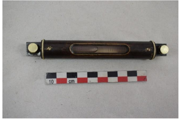
Εικόνα 170 Πάνω όψη της σωληνωτής αεροστάθμης, μετά τη συντήρηση (Μαύρος χωροβάτης). ©Γερμανικό Αρχαιολογικό Ινστιτούτο, Εργαστήριο Συντήρησης Μεταλλικών Αντικειμένων, Πα.Δ.Α. (Ε. Αναμουρλίδου, Α. Σαμπάνης).
