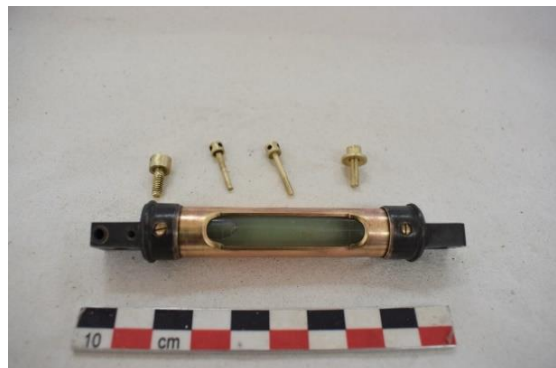
Εικόνα 178 Επάνω όψη σωληνωτής αεροστάθμης βραχιόνων, μετά τη συντήρηση (Διόπτρα μετροτράπεζας). ©Γερμανικό Αρχαιολογικό Ινστιτούτο, Εργαστήριο Συντήρησης Μεταλλικών Αντικειμένων, Πα.Δ.Α. (Ε. Αναμουρλίδου, Α. Σαμπάνης).
