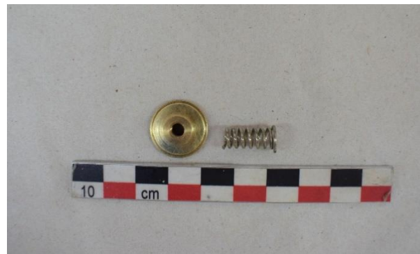
Εικόνα 241 Οπίσθια όψη κοχλία τηλεσκοπίου, μετά τη συντήρηση (Μικρός χωροβάτης). ©Γερμανικό Αρχαιολογικό Ινστιτούτο, Εργαστήριο Συντήρησης Μεταλλικών Αντικειμένων, Πα.Δ.Α. (Ε. Αναμουρλίδου, Α. Σαμπάνης).
