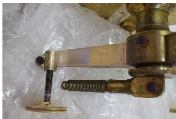
Εικόνα 135 Ο βραχίονας του τριχοχλίου, μετά το χημικό καθαρισμό με μηχανική υποβοήθηση. ©Γερμανικό Αρχαιολογικό Ινστιτούτο, Εργαστήριο Συντήρησης Μεταλλικών Αντικειμένων, Πα.Δ.Α. (Ε. Αναμουρλίδου, Α. Σαμπάνης).
