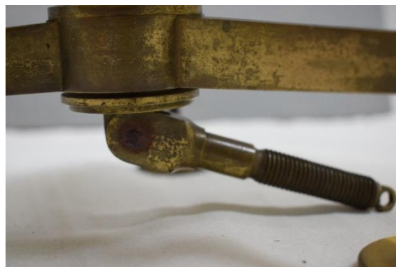
Εικόνα 29 Το άγκιστρο κάτω από το τρικόχλιο. ©Γερμανικό Αρχαιολογικό Ινστιτούτο, Εργαστήριο Συντήρησης Μεταλλικών Αντικειμένων, Πα.Δ.Α. (Ε. Αναμουρλίδου, Α. Σαμπάνης)
