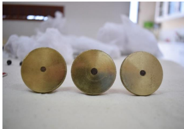
Εικόνα 271 Οι κοχλίες του τρικοχλίου, μετά τη συντήρηση (Θεοδόλιχος). ©Γερμανικό Αρχαιολογικό Ινστιτούτο, Εργαστήριο Συντήρησης Μεταλλικών Αντικειμένων, Πα.Δ.Α. (Ε. Αναμουρλίδου, Α. Σαμπάνης).
