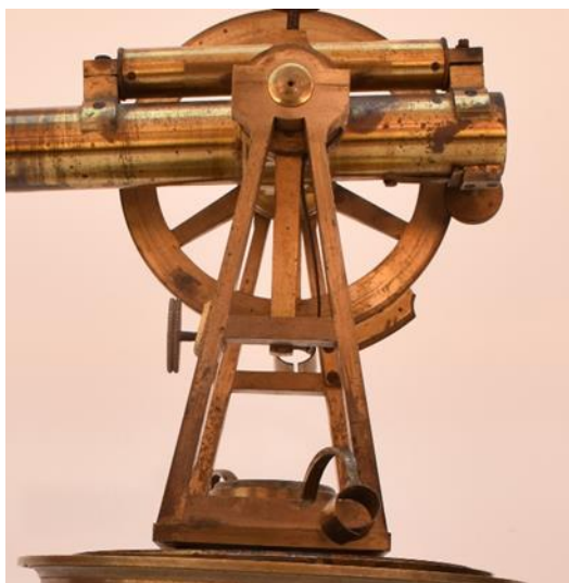
Εικόνα 32 Ο βραχίονας άντυγα εξασφαλίζει την συγκράτηση του τηλεσκοπίου και την σύνδεση του άνω μέρους του θεοδόλιχου με τη βάση του. ,©Γερμανικό Αρχαιολογικό Ινστιτούτο, Εργαστήριο Συντήρησης Μεταλλικών Αντικειμένων, Πα.Δ.Α. (Ε. Αναμουρλίδου, Α. Σαμπάνης)
