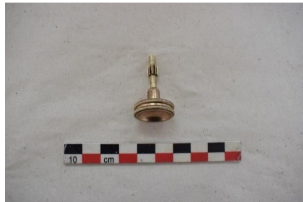
Εικόνα 182 Άνω όψη του κοχλία εστίασης, μετά τη συντήρηση (Διόπτρα μετροτράπεζας). ©Γερμανικό Αρχαιολογικό Ινστιτούτο, Εργαστήριο Συντήρησης Μεταλλικών Αντικειμένων, Πα.Δ.Α. (Ε. Αναμουρλίδου, Α. Σαμπάνης).
