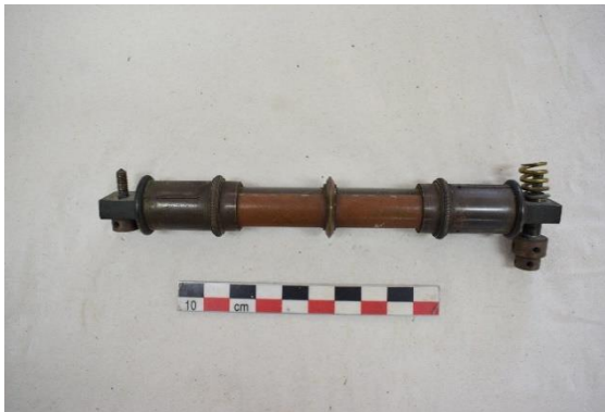
Εικόνα 185 Πλάγια όψη σωληνωτής αεροστάθμης τηλεσκοπίου, πριν τη συντήρηση (Διόπτρα μετροτράπεζας). ©Γερμανικό Αρχαιολογικό Ινστιτούτο, Εργαστήριο Συντήρησης Μεταλλικών Αντικειμένων, Πα.Δ.Α. (Ε. Αναμουρλίδου, Α. Σαμπάνης).
