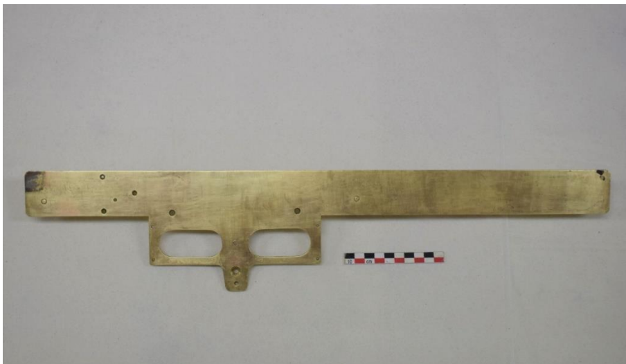
Εικόνα 141 Η οπίσθια όψη του κανόνα μετά τη συντήρηση. Στην πάνω αριστερή γωνία διακρίνεται ο μάρτυρας της αρχικής κατάστασης, που αφήσαμε. ©Γερμανικό Αρχαιολογικό Ινστιτούτο, Εργαστήριο Συντήρησης Μεταλλικών Αντικειμένων, Πα.Δ.Α. (Ε. Αναμουρλίδου, Α. Σαμπάνης).
