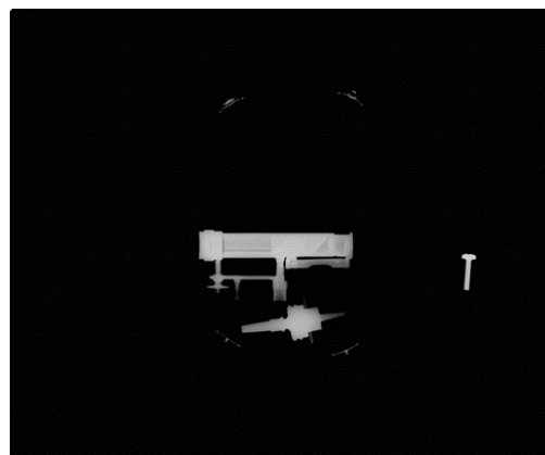
Εικόνα 80 Αποτέλεσμα της ακτινογράφισης (100 kVp, 80 mAs), αποτυπώθηκε όλο το σύνολο του αντικειμένου.
