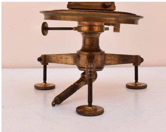
Εικόνα 28 Το τρικόχλιο στο κίτρινο θεοδόλιχο, με εμφανή τους τρεις κοχλίες ως πόδια. ©Γερμανικό Αρχαιολογικό Ινστιτούτο, Εργαστήριο Συντήρησης Μεταλλικών Αντικειμένων, Πα.Δ.Α. (Ε. Αναμουρλίδου, Α. Σαμπάνης)
