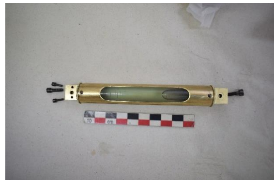
Εικόνα 303 Σωληνωτή αεροστάθμη του τηλεσκοπίου, μετά την συντήρηση (Θεοδόλιχος). ©Γερμανικό Αρχαιολογικό Ινστιτούτο, Εργαστήριο Συντήρησης Μεταλλικών Αντικειμένων, Πα.Δ.Α. (Ε. Αναμουρλίδου, Α. Σαμπάνης).
