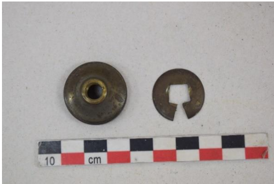
Εικόνα 201 Πώμα κοχλία ατράκτου, πριν τη συντήρηση (Διόπτρα μετροτράπεζας). ©Γερμανικό Αρχαιολογικό Ινστιτούτο, Εργαστήριο Συντήρησης Μεταλλικών Αντικειμένων, Πα.Δ.Α. (Ε. Αναμουρλίδου, Α. Σαμπάνης).
