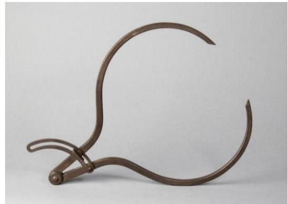
Εικόνα 6 Διαβήτης (κουμπάσο). (©Αρχείο Γ.Α.Ι., D-DAI-ATH-2019-00017)
