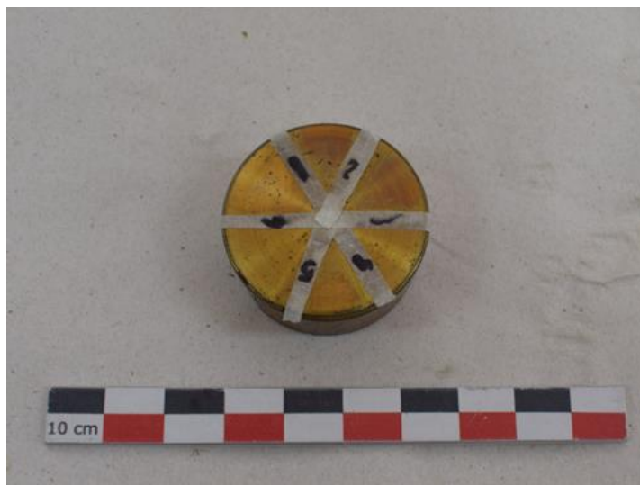
Εικόνα 122 Το κάλυπτρο του Θεοδόλιχου μετά τις δοκιμές. Είναι εμφανής οι ιριδισμοί στις δοκιμές 1 & 2 και παρατηρείται καθαρή και χωρίς ιριδισμό η δοκιμή 6. ©Γερμανικό Αρχαιολογικό Ινστιτούτο, Εργαστήριο Συντήρησης Μεταλλικών Αντικειμένων, Πα.Δ.Α. (Ε. Αναμουρλίδου, Α. Σαμπάνης).
