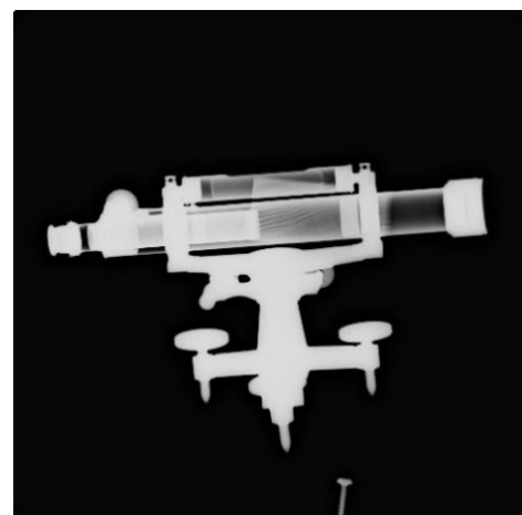
Εικόνα 72 Το αποτέλεσμα της ακτινογράφισης από τη πλάγια όψη του Μαύρου χωροβάτη (110 KVp, 100 mAs).
