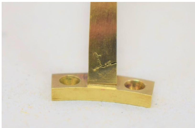
Εικόνα 116 Μικρό ρωγμή στη βάση βραχίονα μικροσκοπίου του κίτρινου θεοδόλιχου. ©Γερμανικό Αρχαιολογικό Ινστιτούτο, Εργαστήριο Συντήρησης Μεταλλικών Αντικειμένων, Πα.Δ.Α. (Ε. Αναμουρλίδου, Α. Σαμπάνης).
