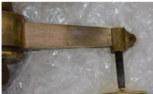
Εικόνα 131 Βραχίονας τρικοχλίου, πριν τις δοκιμές. ©Γερμανικό Αρχαιολογικό Ινστιτούτο, Εργαστήριο Συντήρησης Μεταλλικών Αντικειμένων, Πα.Δ.Α. (Ε. Αναμουρλίδου, Α. Σαμπάνης).
