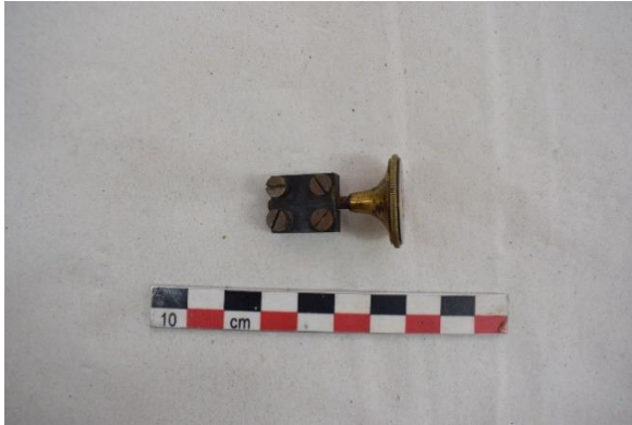
Εικόνα 165 Επάνω όψη του κοχλία εστίασης, πριν τη συντήρηση (Μαύρος χωροβάτης). ©Γερμανικό Αρχαιολογικό Ινστιτούτο, Εργαστήριο Συντήρησης Μεταλλικών Αντικειμένων, Πα.Δ.Α. (Ε. Αναμουρλίδου, Α. Σαμπάνης).
