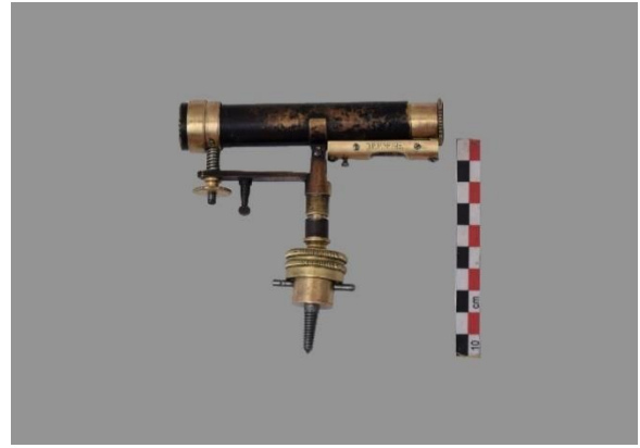
Εικόνα 307 Οπίσθια όψη του Μικρού χωροβάτη, μετά τη συντήρηση ,©Γερμανικό Αρχαιολογικό Ινστιτούτο, Εργαστήριο Συντήρησης Μεταλλικών Αντικειμένων, Πα.Δ.Α. (Ε. Αναμουρλίδου, Α. Σαμπάνης)
