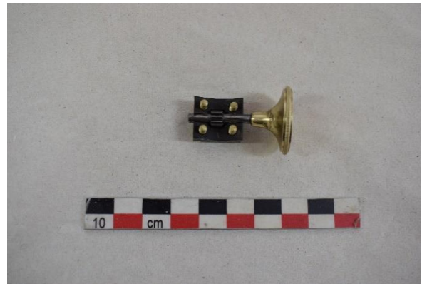
Εικόνα 168 Κάτω όψη του κοχλία εστίασης, πριν τη συντήρηση (Μαύρος χωροβάτης). ©Γερμανικό Αρχαιολογικό Ινστιτούτο, Εργαστήριο Συντήρησης Μεταλλικών Αντικειμένων, Πα.Δ.Α. (Ε. Αναμουρλίδου, Α. Σαμπάνης).
