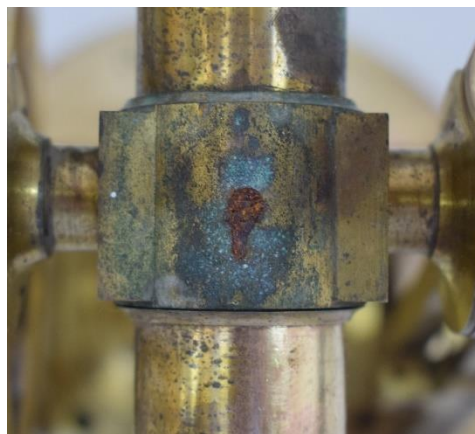
Εικόνα 112 Γαλαζοπράσινα προϊόντα διάβρωσης πάνω από το τηλεσκόπιο και κάτω από τη σωληνωτή αεροστάθμη του «κίτρινου θεοδόλιχου». ©Γερμανικό Αρχαιολογικό Ινστιτούτο, Εργαστήριο Συντήρησης Μεταλλικών Αντικειμένων, Πα.Δ.Α. (Ε. Αναμουρλίδου, Α. Σαμπάνης).
