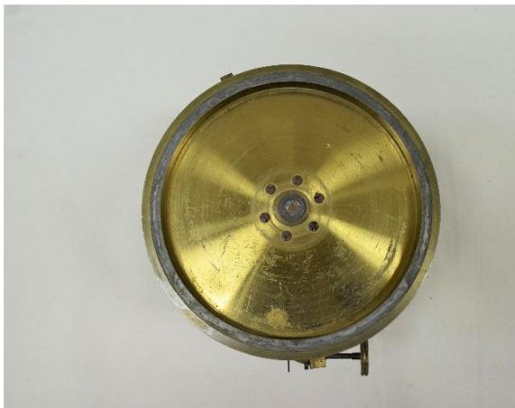
Εικόνα 260 Άνω μέρος οριζόντιου κύκλου, πριν τη συντήρηση (Θεοδόλιχος). ©Γερμανικό Αρχαιολογικό Ινστιτούτο, Εργαστήριο Συντήρησης Μεταλλικών Αντικειμένων, Πα.Δ.Α. (Ε. Αναμουρλίδου, Α. Σαμπάνης).
