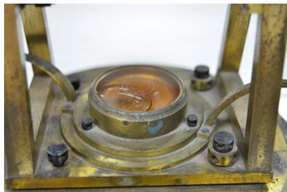
Εικόνα 36 Σφαιρική αεροστάθμη, για χονδρική οριζόντιωση, ανάμεσα των βραχιόνων άντυγα. ©Γερμανικό Αρχαιολογικό Ινστιτούτο, Εργαστήριο Συντήρησης Μεταλλικών Αντικειμένων, Πα.Δ.Α. (Ε. Αναμουρλίδου, Α. Σαμπάνης)
