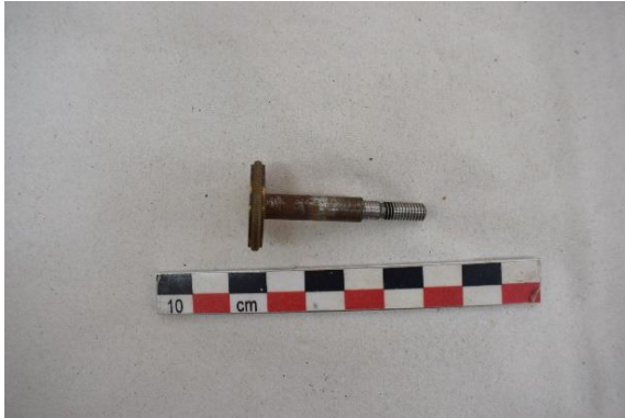
Εικόνα 153 Ο κοχλίας σύσφιξης, πριν τη συντήρηση (Μαύρος χωροβάτης). ©Γερμανικό Αρχαιολογικό Ινστιτούτο, Εργαστήριο Συντήρησης Μεταλλικών Αντικειμένων, Πα.Δ.Α. (Ε. Αναμουρλίδου, Α. Σαμπάνης).
