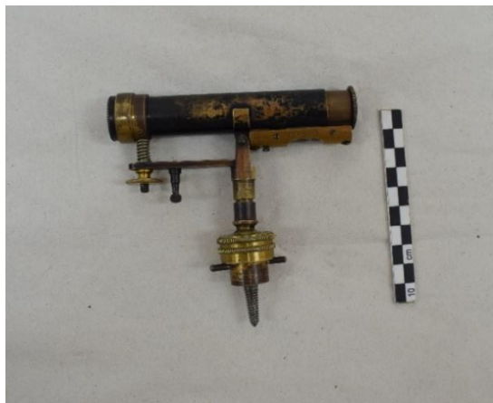
Εικόνα 258 Ο μικρός χωροβάτης, πριν τη συντήρηση (Μικρός χωροβάτης). ©Γερμανικό Αρχαιολογικό Ινστιτούτο, Εργαστήριο Συντήρησης Μεταλλικών Αντικειμένων, Πα.Δ.Α. (Ε. Αναμουρλίδου, Α. Σαμπάνης).
