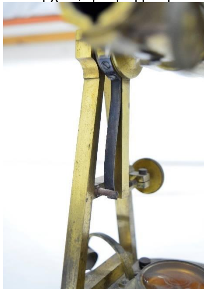
Εικόνα 35 Η γερμανική τροποποίηση, του κατακόρυφου σφιγκτήρα. Το μεταλλικό έλασμα πίσω από τον ανασταλτικό κοχλία. ,©Γερμανικό Αρχαιολογικό Ινστιτούτο, Εργαστήριο Συντήρησης Μεταλλικών Αντικειμένων, Πα.Δ.Α. (Ε. Αναμουρλίδου, Α. Σαμπάνης)
