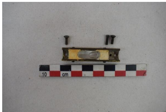
Εικόνα 234 Οπίσθια όψη της σωληνωτής αεροστάθμης, πριν τη συντήρηση (Μικρός χωροβάτης). ©Γερμανικό Αρχαιολογικό Ινστιτούτο, Εργαστήριο Συντήρησης Μεταλλικών Αντικειμένων, Πα.Δ.Α. (Ε. Αναμουρλίδου, Α. Σαμπάνης).
