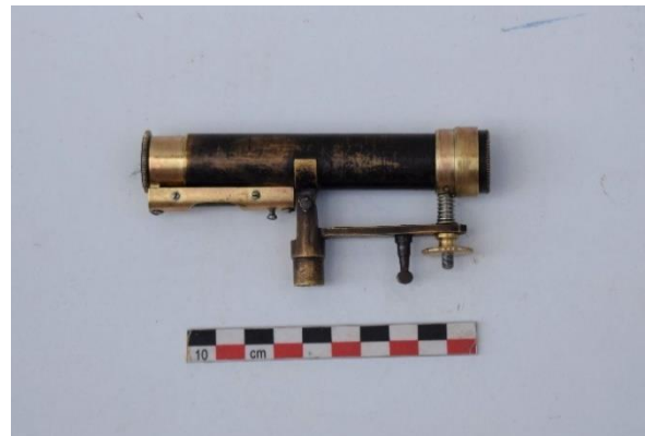
Εικόνα 255 Άνω μέρος μικρού χωροβάτη, μετά τη συντήρηση (Μικρός χωροβάτης). ©Γερμανικό Αρχαιολογικό Ινστιτούτο, Εργαστήριο Συντήρησης Μεταλλικών Αντικειμένων, Πα.Δ.Α. (Ε. Αναμουρλίδου, Α. Σαμπάνης).
