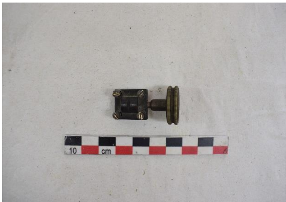
Εικόνα 181 Άνω όψη του κοχλία εστίασης, πριν τη συντήρηση (Διόπτρα μετροτράπεζας). ©Γερμανικό Αρχαιολογικό Ινστιτούτο, Εργαστήριο Συντήρησης Μεταλλικών Αντικειμένων, Πα.Δ.Α. (Ε. Αναμουρλίδου, Α. Σαμπάνης).
