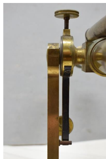
Εικόνα 34 Ο κατακόρυφος σφιγκτήρας. Πάνω ο κοχλίας σύσφιξης και κάτω ο ανασταλτικός κοχλίας. ,©Γερμανικό Αρχαιολογικό Ινστιτούτο, Εργαστήριο Συντήρησης Μεταλλικών Αντικειμένων, Πα.Δ.Α. (Ε. Αναμουρλίδου, Α. Σαμπάνης)
