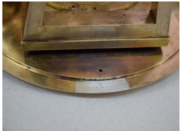
Εικόνα 285 Δείκτης θεοδόλιχου, μετά τη συντήρηση (Θεοδόλιχος). ©Γερμανικό Αρχαιολογικό Ινστιτούτο, Εργαστήριο Συντήρησης Μεταλλικών Αντικειμένων, Πα.Δ.Α. (Ε. Αναμουρλίδου, Α. Σαμπάνης).
