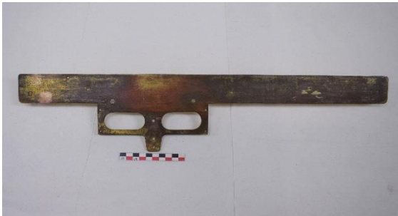
Εικόνα 209 Οπίσθια όψη κανόνα της διόπτρας, πριν τη συντήρηση (Διόπτρα μετροτράπεζας). ©Γερμανικό Αρχαιολογικό Ινστιτούτο, Εργαστήριο Συντήρησης Μεταλλικών Αντικειμένων, Πα.Δ.Α. (Ε. Αναμουρλίδου, Α. Σαμπάνης).
