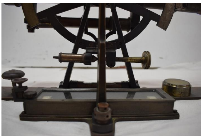
Εικόνα 55 Ο ανασταλτικός κοχλίας με το κύλινδρο ελατηρίου, όπως τοποθετείται ανάμεσα των βραχιόνων. ©Γερμανικό Αρχαιολογικό Ινστιτούτο, Εργαστήριο Συντήρησης Μεταλλικών Αντικειμένων, Πα.Δ.Α. (Ε. Αναμουρλίδου, Α. Σαμπάνης).
