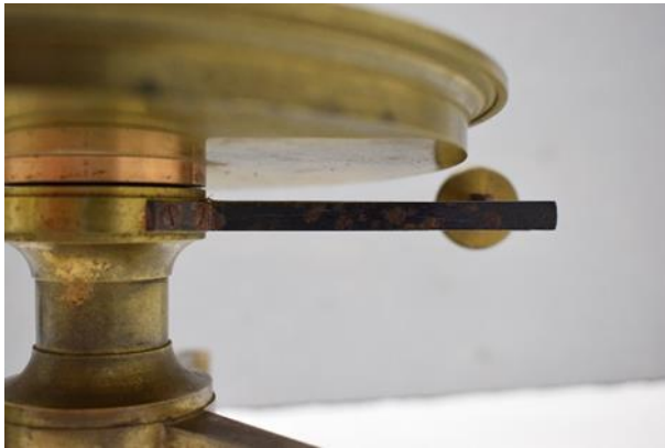
Εικόνα 26 Η ύπαρξη σιδερένιου ελάσματος πίσω από τον ανασταλτικό κοχλία. ©Γερμανικό Αρχαιολογικό Ινστιτούτο, Εργαστήριο Συντήρησης Μεταλλικών Αντικειμένων, Πα.Δ.Α. (Ε. Αναμουρλίδου, Α. Σαμπάνης)
