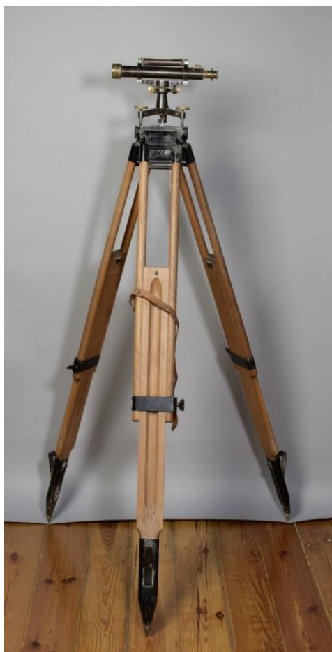
Εικόνα 14 Μαύρος χωροβάτης πάνω σε τρίποδο( ©Αρχείο Γ.Α.Ι., D-DAI-ATH-2019-00034)
