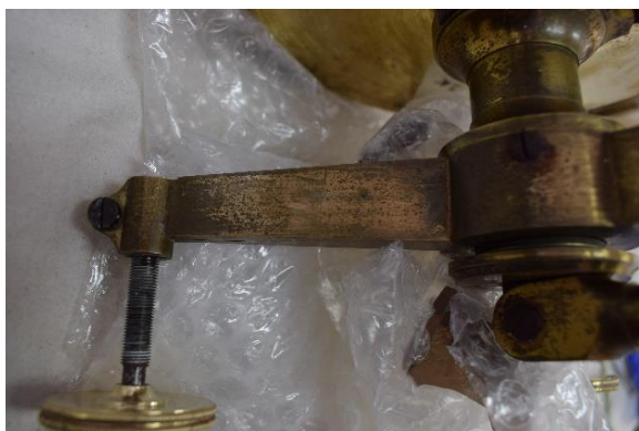
Εικόνα 133 Ο βραχίονας του τριχοχλίου, πριν την δοκιμή. ©Γερμανικό Αρχαιολογικό Ινστιτούτο, Εργαστήριο Συντήρησης Μεταλλικών Αντικειμένων, Πα.Δ.Α. (Ε. Αναμουρλίδου, Α. Σαμπάνης).
