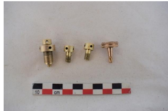
Εικόνα 227 Κοχλίες των βραχιόνων της άντυγα, μετά τη συντήρηση (Διόπτρα μετροτράπεζας). ©Γερμανικό Αρχαιολογικό Ινστιτούτο, Εργαστήριο Συντήρησης Μεταλλικών Αντικειμένων, Πα.Δ.Α. (Ε. Αναμουρλίδου, Α. Σαμπάνης).
