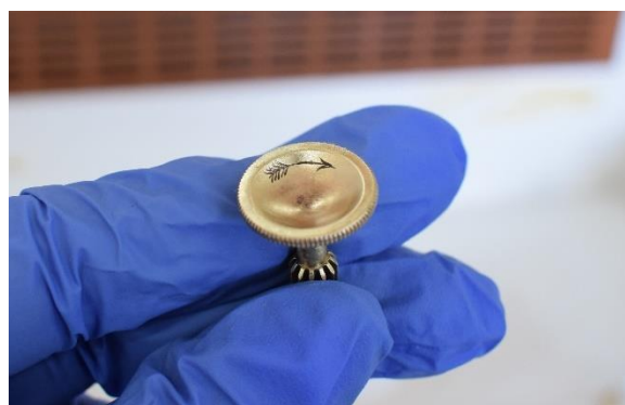
Εικόνα 144 Βέλος φοράς περιστροφής του κοχλία του κλισιμέτρου στη "διόπτρα μετεροτράπεζας". ©Γερμανικό Αρχαιολογικό Ινστιτούτο, Εργαστήριο Συντήρησης Μεταλλικών Αντικειμένων, Πα.Δ.Α. (Ε. Αναμουρλίδου, Α. Σαμπάνης).
