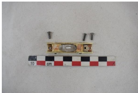
Εικόνα 235 Οπίσθια όψη της σωληνωτής αεροστάθμης, μετά τη συντήρηση (Μικρός χωροβάτης). ©Γερμανικό Αρχαιολογικό Ινστιτούτο, Εργαστήριο Συντήρησης Μεταλλικών Αντικειμένων, Πα.Δ.Α. (Ε. Αναμουρλίδου, Α. Σαμπάνης).
