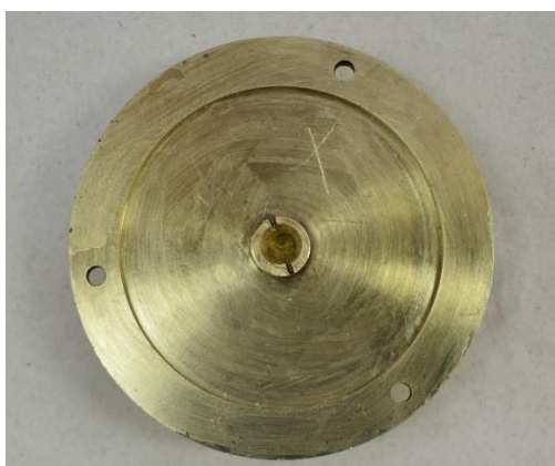
Εικόνα 143 Το "X" στην οπίσθια όψη της σφαιρικής αεροστάθμης δηλώνει ποια οπή πρέπει να βιδωθεί πρώτη. ©Γερμανικό Αρχαιολογικό Ινστιτούτο, Εργαστήριο Συντήρησης Μεταλλικών Αντικειμένων, Πα.Δ.Α. (Ε. Αναμουρλίδου, Α. Σαμπάνης).
