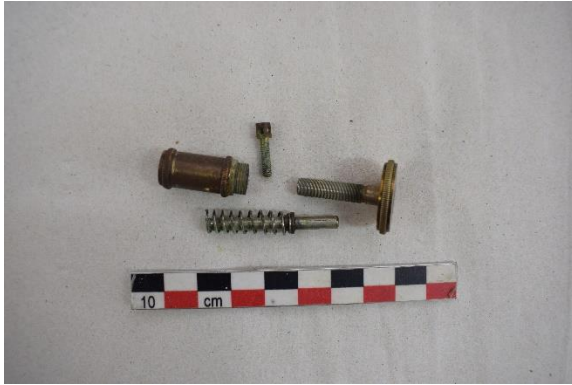
Εικόνα 151 Τα εξαρτήματα του ανασταλτικού κοχλίου, πριν τη συντήρηση (Μαύρος χωροβάτης). ©Γερμανικό Αρχαιολογικό Ινστιτούτο, Εργαστήριο Συντήρησης Μεταλλικών Αντικειμένων, Πα.Δ.Α. (Ε. Αναμουρλίδου, Α. Σαμπάνης).
