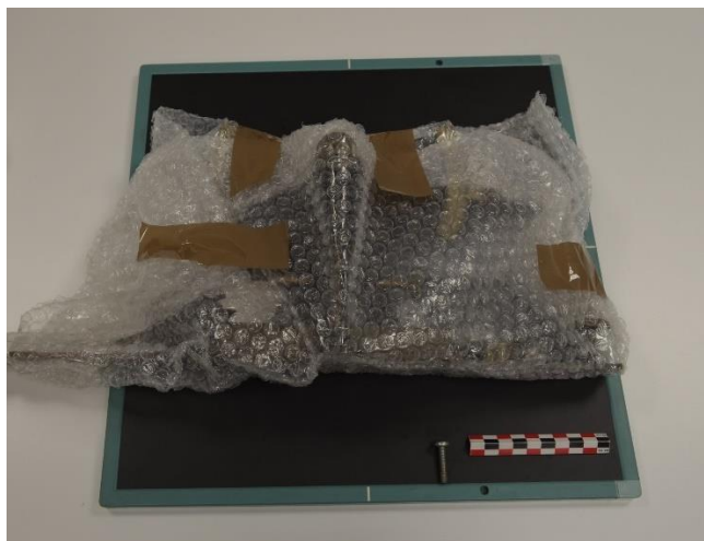
Εικόνα 67 Τοποθέτηση της τηλεσκοπικής διόπτρας για την δεύτερη ακτινογράφιση από πλάγια του αντικειμένου. ©Γερμανικό Αρχαιολογικό Ινστιτούτο, Εργαστήριο Συντήρησης Μεταλλικών Αντικειμένων, Πα.Δ.Α. (Ε. Αναμουρλίδου, Α. Σαμπάνης).
