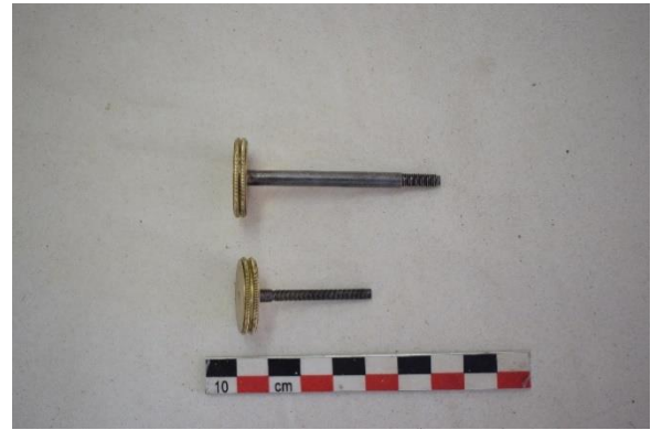
Εικόνα 289 Ο οριζόντιος σφικτικός και ανασταλτικός κοχλίας, μετά τη συντήρηση (Θεοδόλιχος). ©Γερμανικό Αρχαιολογικό Ινστιτούτο, Εργαστήριο Συντήρησης Μεταλλικών Αντικειμένων, Πα.Δ.Α. (Ε. Αναμουρλίδου, Α. Σαμπάνης).
