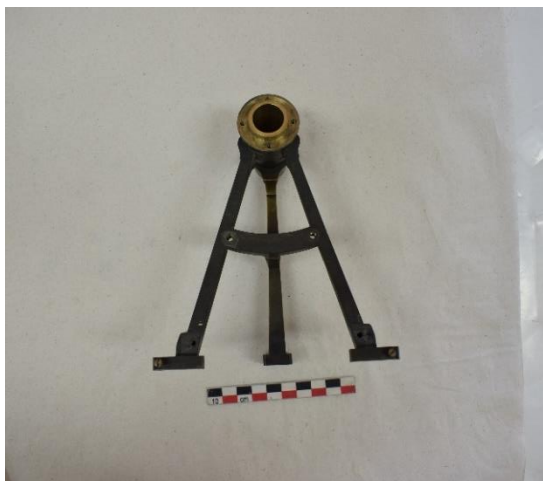
Εικόνα 213 Οι βραχίονες άντυγα της διόπτρας, πριν τη συντήρηση (Διόπτρα μετροτράπεζας). ©Γερμανικό Αρχαιολογικό Ινστιτούτο, Εργαστήριο Συντήρησης Μεταλλικών Αντικειμένων, Πα.Δ.Α. (Ε. Αναμουρλίδου, Α. Σαμπάνης).
