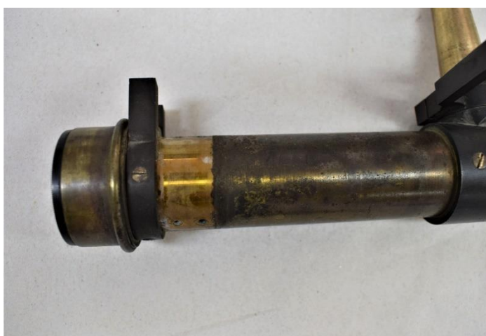
Εικόνα 118 Η περιοχή του καθαρού βερνικιού που καλυπτόταν από εξάρτημα σε σχέση με τη διαβρωμένη ακάλυπτη περιοχή. ©Γερμανικό Αρχαιολογικό Ινστιτούτο, Εργαστήριο Συντήρησης Μεταλλικών Αντικειμένων, Πα.Δ.Α. (Ε. Αναμουρλίδου, Α. Σαμπάνης).
