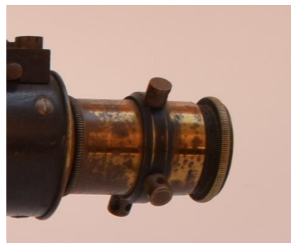
Εικόνα 43 Το διάφραγμα με τις τρεις βίδες προσαρμογής του. ©Γερμανικό Αρχαιολογικό Ινστιτούτο, Εργαστήριο Συντήρησης Μεταλλικών Αντικειμένων, Πα.Δ.Α. (Ε. Αναμουρλίδου, Α. Σαμπάνης)
