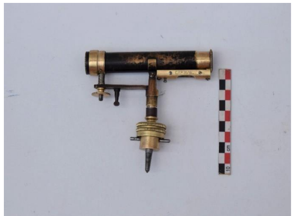
Εικόνα 259 Ο μικρός χωροβάτης, μετά τη συντήρηση (Μικρός χωροβάτης). ©Γερμανικό Αρχαιολογικό Ινστιτούτο, Εργαστήριο Συντήρησης Μεταλλικών Αντικειμένων, Πα.Δ.Α. (Ε. Αναμουρλίδου, Α. Σαμπάνης).
