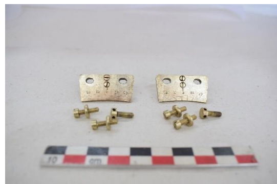
Εικόνα 206 Εμπρόσθια όψη βερνιέρων κύκλου, μετά τη συντήρηση (Διόπτρα μετροτράπεζας). ©Γερμανικό Αρχαιολογικό Ινστιτούτο, Εργαστήριο Συντήρησης Μεταλλικών Αντικειμένων, Πα.Δ.Α. (Ε. Αναμουρλίδου, Α. Σαμπάνης).
