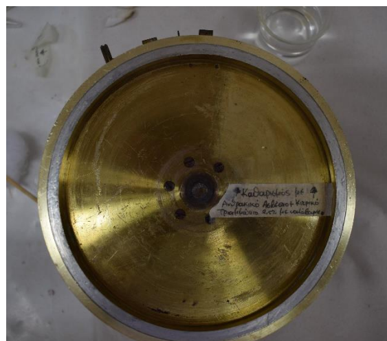
Εικόνα 130 Ο οριζόντιος κύκλος, μετά την επέμβαση της πηκτής ξανθάνης με κιτρικό τριαμμώνιο 5%. ©Γερμανικό Αρχαιολογικό Ινστιτούτο, Εργαστήριο Συντήρησης Μεταλλικών Αντικειμένων, Πα.Δ.Α. (Ε. Αναμουρλίδου, Α. Σαμπάνης).
