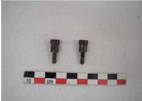
Εικόνα 224 Κοχλίες του κατακόρυφου κύκλου, πριν τη συντήρηση (Διόπτρα μετροτράπεζας). ©Γερμανικό Αρχαιολογικό Ινστιτούτο, Εργαστήριο Συντήρησης Μεταλλικών Αντικειμένων, Πα.Δ.Α. (Ε. Αναμουρλίδου, Α. Σαμπάνης).
