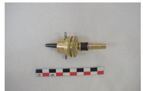
Εικόνα 249 Βάση μικρού χωροβάτη, μετά τη συντήρηση (Μικρός χωροβάτης). ©Γερμανικό Αρχαιολογικό Ινστιτούτο, Εργαστήριο Συντήρησης Μεταλλικών Αντικειμένων, Πα.Δ.Α. (Ε. Αναμουρλίδου, Α. Σαμπάνης).
