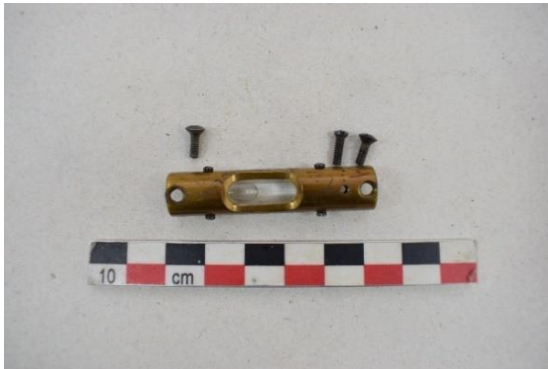
Εικόνα 232 Εμπρόσθια όψη σωληνωτής αεροστάθμης, πριν τη συντήρηση (Μικρός χωροβάτης). ©Γερμανικό Αρχαιολογικό Ινστιτούτο, Εργαστήριο Συντήρησης Μεταλλικών Αντικειμένων, Πα.Δ.Α. (Ε. Αναμουρλίδου, Α. Σαμπάνης).
