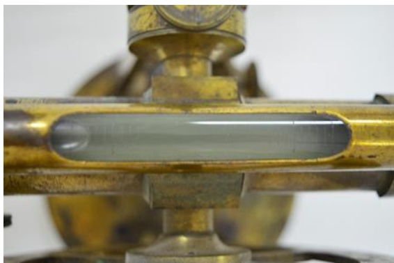
Εικόνα 30 Σωληνωτή αεροστάθμη, για ακριβή οριζοντίωση, επάνω από το τηλεσκόπιο. ©Γερμανικό Αρχαιολογικό Ινστιτούτο, Εργαστήριο Συντήρησης Μεταλλικών Αντικειμένων, Πα.Δ.Α. (Ε. Αναμουρλίδου, Α. Σαμπάνης)
