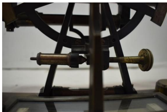
Εικόνα 199 Τα εξαρτήματα του ανασταλτικού κοχλία πάνω στη διόπτρα, πριν τη συντήρηση (Διόπτρα μετροτράπεζας). ©Γερμανικό Αρχαιολογικό Ινστιτούτο, Εργαστήριο Συντήρησης Μεταλλικών Αντικειμένων, Πα.Δ.Α. (Ε. Αναμουρλίδου, Α. Σαμπάνης).
