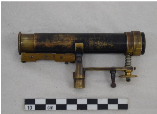
Εικόνα 254 Άνω μέρος μικρού χωροβάτη, μετά τη συντήρηση (Μικρός χωροβάτης). ©Γερμανικό Αρχαιολογικό Ινστιτούτο, Εργαστήριο Συντήρησης Μεταλλικών Αντικειμένων, Πα.Δ.Α. (Ε. Αναμουρλίδου, Α. Σαμπάνης).
