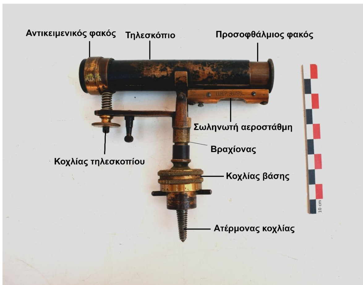
Εικόνα 49 Τα μέρη που απαρτίζουν το "μικρό χωροβάτη", ©Γερμανικό Αρχαιολογικό Ινστιτούτο, Εργαστήριο Συντήρησης Μεταλλικών Αντικειμένων, Πα.Δ.Α. (Ε. Αναμουρλίδου, Α. Σαμπάνης).
