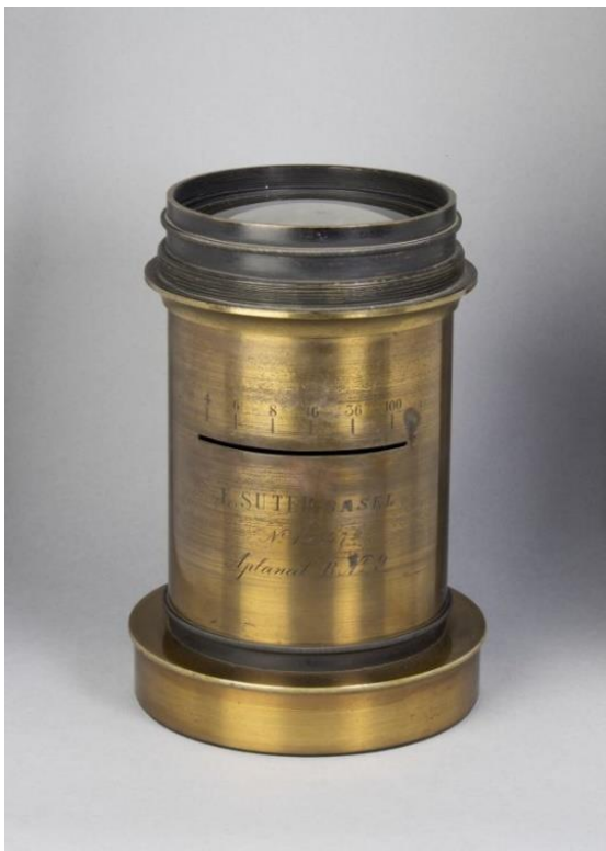
Εικόνα 7 Φακός ευθυγράμμισης. (©Αρχείο Γ.Α.Ι., D-DAI-ATH-2019-00018)
