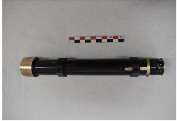
Εικόνα 148 Το τηλεσκόπιο του χωροβάτη, μετά τη συντήρηση (Μαύρος χωροβάτης). ©Γερμανικό Αρχαιολογικό Ινστιτούτο, Εργαστήριο Συντήρησης Μεταλλικών Αντικειμένων, Πα.Δ.Α. (Ε. Αναμουρλίδου, Α. Σαμπάνης).
