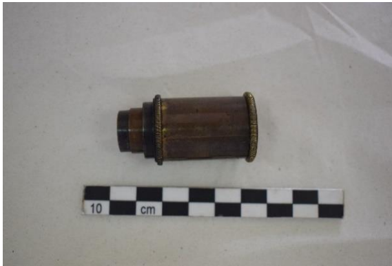
Εικόνα 292 Ο προσοφθάλμιος φακός του θεοδόλιχου, πριν τη συντήρηση (Θεοδόλιχος). ©Γερμανικό Αρχαιολογικό Ινστιτούτο, Εργαστήριο Συντήρησης Μεταλλικών Αντικειμένων, Πα.Δ.Α. (Ε. Αναμουρλίδου, Α. Σαμπάνης).
