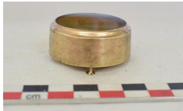
Εικόνα 223 Πλάγια όψη της σφαιρικής αεροστάθμης του κανόνα, μετά τη συντήρηση (Διόπτρα μετροτράπεζας). ©Γερμανικό Αρχαιολογικό Ινστιτούτο, Εργαστήριο Συντήρησης Μεταλλικών Αντικειμένων, Πα.Δ.Α. (Ε. Αναμουρλίδου, Α. Σαμπάνης).
