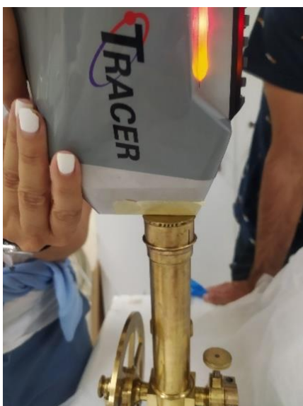
Εικόνα 107 Ανάλυση στον αντικειμενικό φακό. ©Γερμανικό Αρχαιολογικό Ινστιτούτο, Εργαστήριο Συντήρησης Μεταλλικών Αντικειμένων, Πα.Δ.Α. (Ε. Αναμουρλίδου, Α. Σαμπάνης).
