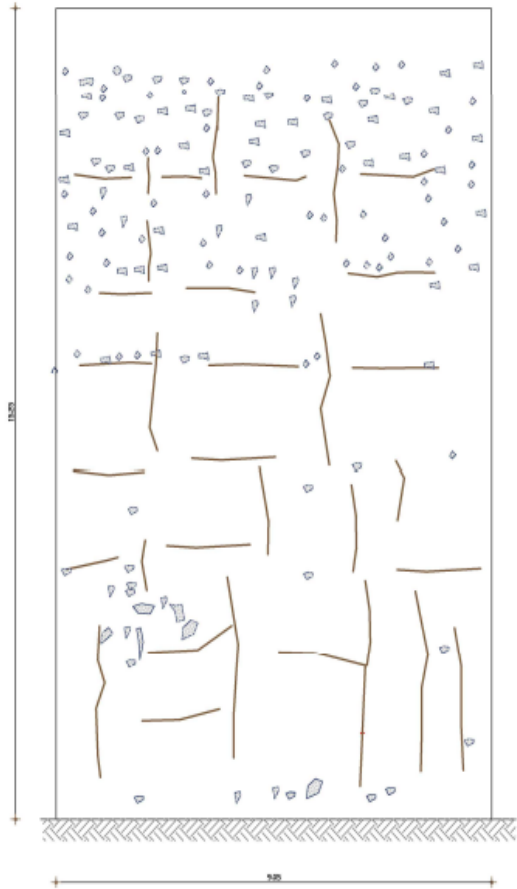
Σχέδιο 9 : Αποτύπωση επισκευών υποστρώματος Λ. Γιαννακόπουλου
