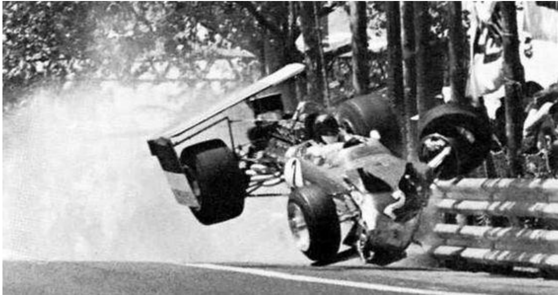
Εικόνα 4 Η στιγμή που το πίσω φτερό της Lotus 49B του Jochen Rindt απέτυχε, στο Ισπανικό Grand Prix του 1969 (imgur, n.a)
