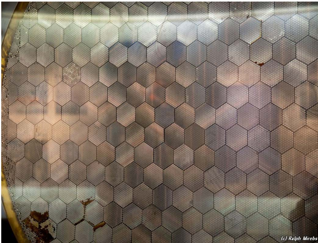
Εικόνα 6 Η διατομή του καλωδίου με τους 37.000 κλώνους
