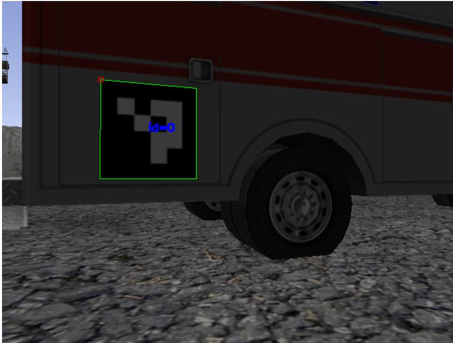
Εικόνα 18. Οπτικοποίηση του εντοπισμού του Aruco Marker με ID = 0 από το POIDN μέσω της μεθόδου drawDetectedMarkers
