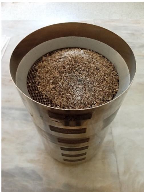
Εικ. 2.1, 2.2: Εισαγωγή της άμμου στη συσκευή κοσκίνισης για κοκκομετρική ανάλυση.
