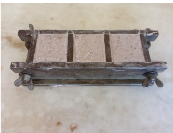
Εικ. 2.7, 2.8: Εισαγωγή των συνθέσεων σε μεταλλικές μήτρες για πρισματικά και κυβικά δοκίμια.
