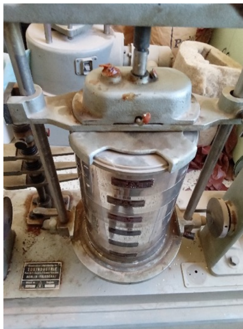
Εικ. 2.1, 2.2: Εισαγωγή της άμμου στη συσκευή κοσκίνισης για κοκκομετρική ανάλυση.
