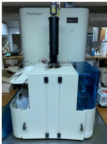
Εικ. 2.36: Ποροσιμετρία εισόδου υδραργύρου (PoreMaster - Quantachrome)
