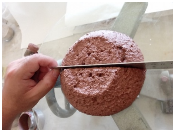
Εικ. 2.5, 2.6: Η σύνθεση με κεραμάλευρο στην τράπεζα εξάπλωσης.
