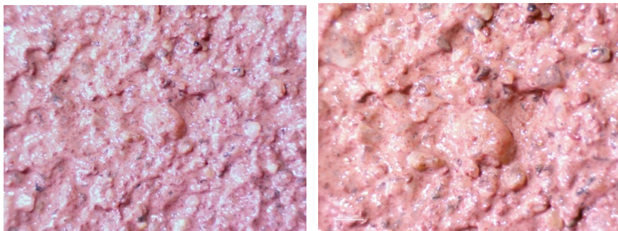
Εικ. 2.15: Νωπό κονίαμα με κεραμάλευρο σε μεγέθυνση 6,7x
