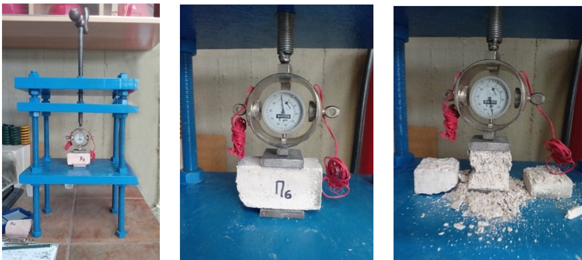
Εικ. 2.39, 2.40, 2.41: Δοκιμή αντοχής σε θλίψη του δοκιμίου Π6 στη χειροκίνητη μηχανή θραύσης.
