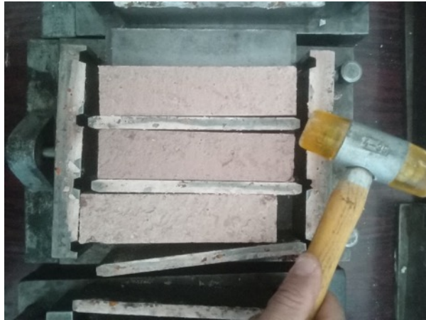
Εικ. 2.11, 2.12: Εξαγωγή των δοκιμών από τις μεταλλικές μήτρες ύστερα από 28 ημέρες.
