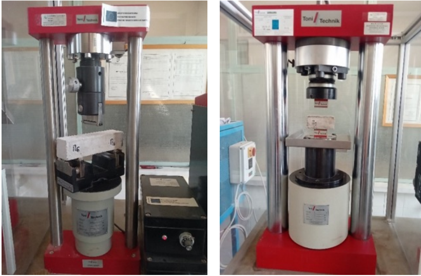
Εικ. 2.37, 2.38: Δοκιμές αντοχής σε κάμψη και σε θλίψη με τη μηχανή θραύσης Toni Technik
