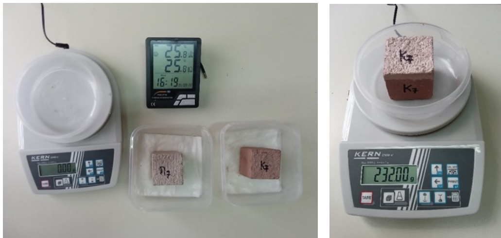
Εικ. 2.33: Δοκιμή τριχοειδούς αναρρίχησης.
