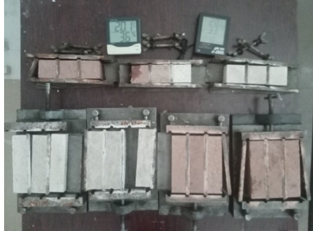
Εικ. 2.11, 2.12: Εξαγωγή των δοκιμών από τις μεταλλικές μήτρες ύστερα από 28 ημέρες.
