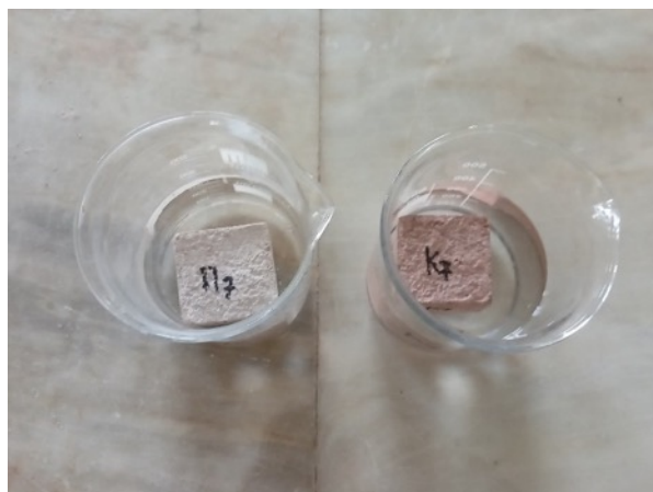
Εικ. 2.35: Δοκιμή ολικής εμβάπτισης.
