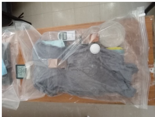
Εικ. 2.9, 2.10: Εισαγωγή των δοκιμών σε περιβάλλον με 100% RH \pm 5, 20° C \pm 5 για 7 ημέρες.
