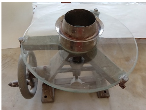
Εικ. 2.5, 2.6: Η σύνθεση με κεραμάλευρο στην τράπεζα εξάπλωσης.
