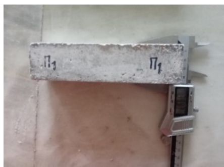
Εικ. 2.31: Μετρήσεις διαστάσεων με ηλεκτρονικό παχύμετρο.
