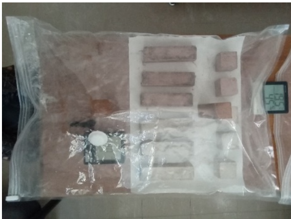
Εικ. 2.9, 2.10: Εισαγωγή των δοκιμών σε περιβάλλον με 100% RH \pm 5, 20° C \pm 5 για 7 ημέρες.
