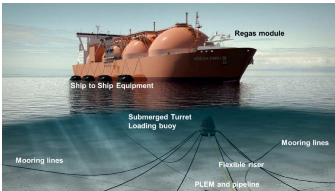
Εικόνα 91: Υποβρύχιο σύστημα πρόσδεσης και σύστημα PLEM (The Oxford Institute for Energy Studies, 2017, p. 20)
