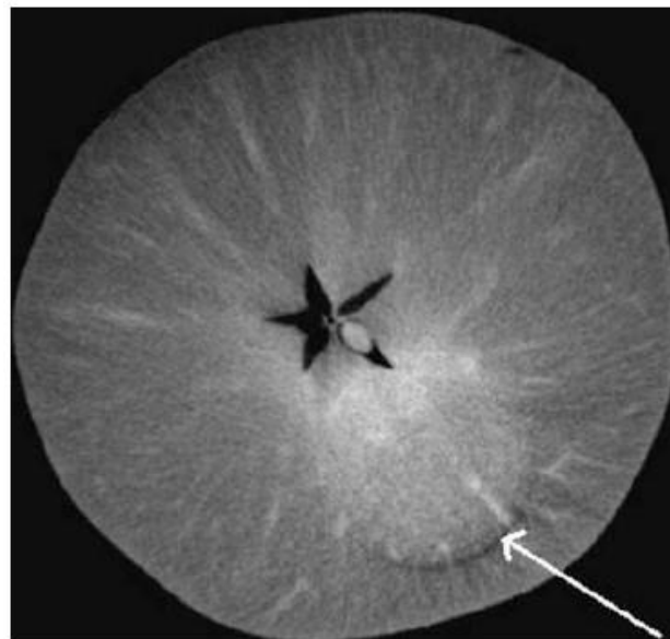
Εικόνα 4.16: Εγκάρσια επαναληπτική ανακατασκευή από ογκομετρική τομογραφία κωνικής δέσμης σε ένα μήλο χωρίς να γίνει διόρθωση του τεχνικού σφάλματος μετατόπισης προβολής (βέλος). (William C. Scarfe, 2018)
