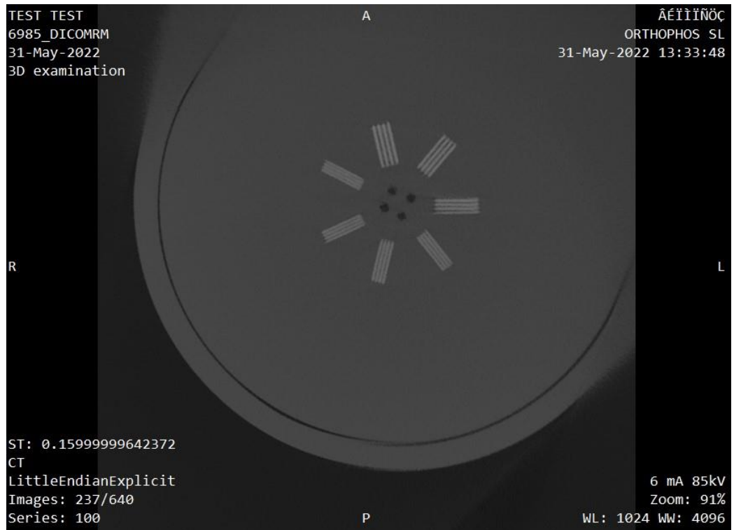
Εικόνα 5.2: Αξιολόγηση της διακριτικής ικανότητας υψηλής αντίθεσης του απεικονιστικού συστήματος τομογραφίας κωνικής δέσμης με τη βοήθεια του οδοντιατρικού ομοιώματος Pro-dent CT MINI που περιλαμβάνει ζεύγη γραμμών ανά mm (lp/mm)
