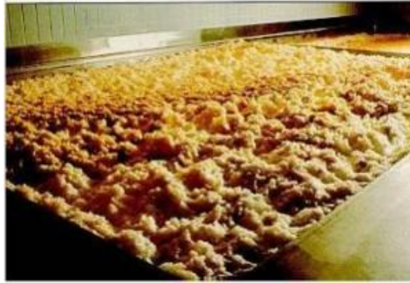
Εικόνα 2.3. Ζύμωση σε παραδοσιακά ανοιχτά οριζόντια δοχεία
