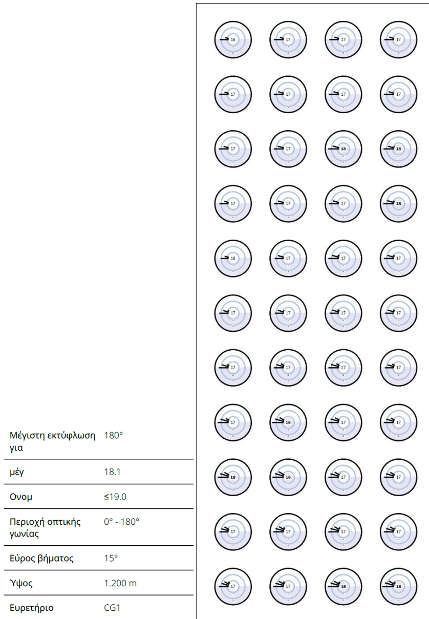
Εικόνα 103 : Συντελεστής UGR φωτισμού από ημισυννεφιασμένο ουρανό σε συνδυασμό με εσωτερικό ηλεκτροφωτισμό απο προσομοίωση DIALux στην επιφάνεια CG1
