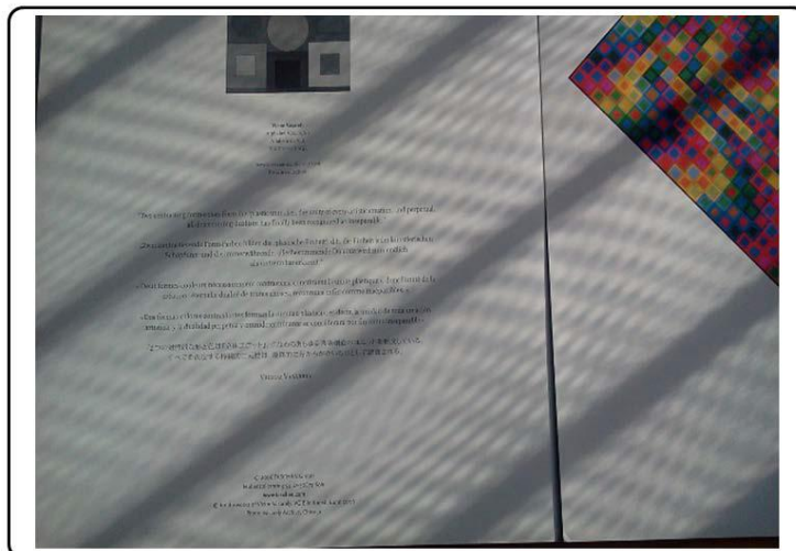
Εικόνα 43 : Δημιουργία μοτίβων στην επιφάνεια εργασίας λόγω του συστήματος σκίασης. [1]
