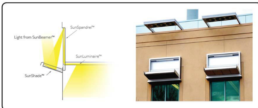
Εικόνα 77 : Αρχή λειτουργίας του Suncentral System (Χρήση εικόνας μετά από άδεια).[1]
