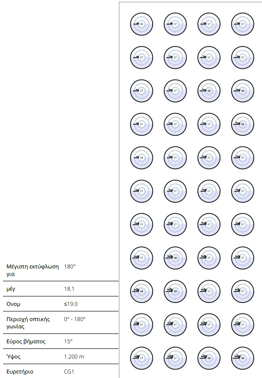
Εικόνα 119 : Συντελεστής UGR φωτισμού από εσωτερικό ηλεκτροφωτισμό απο προσομοίωση DIALux στην επιφάνεια CG1
