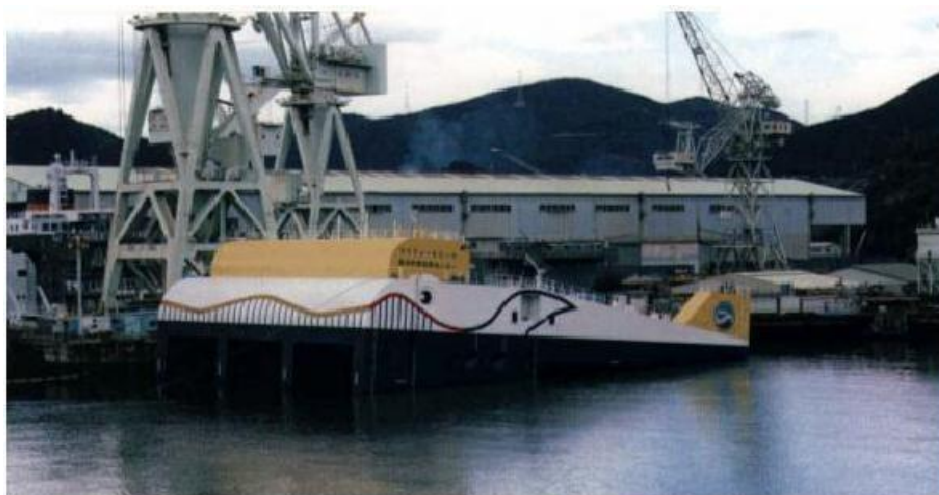
Εικόνα 25. Σύστημα MightyWhale. Πηγή: ΜΑΝΑΛΗΣ ΑΝΤΩΝΙΟΣ ΕΥΑΓΓΕΛΟΣ, Κυματική και Ωκεάνια Ενέργεια, σημερινή πραγματικότητα και μελλοντικές προοπτικές, 2012
