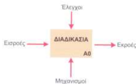
Σχήμα 1.9.3.1 Πλαίσιο Εισροών – Εκροών – Ελέγχων – Μηχανισμών.
