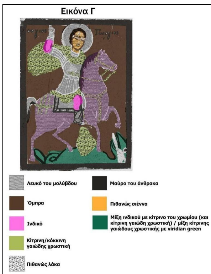
Εικόνα 73: Χαρτογράφηση του συνόλου των χρωστικών που εντοπίστηκαν στην εικόνα Γ.
