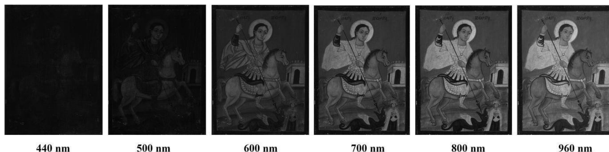
Εικόνα 48: Πολυφασματικές απεικονίσεις ανάκλασης της εικόνας Β που λήφθηκαν με την MuSIS™ HS στις φασματικές ζώνες 440nm, 500nm, 600nm, 700nm, 800nm και 960nm.
