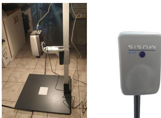
Εικόνα 22: Το φορητό σύστημα υπερφασματικής απεικόνισης MuSIS™ HS και η διάταξη που χρησιμοποιήθηκε.
