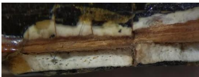
Εικόνα 17: Το λευκό απορροφητικό υπόστρωμα της Εικόνας Β, όπως φαίνεται στην περιοχή απώλειας στην αριστερή ακμή του αντικειμένου.
