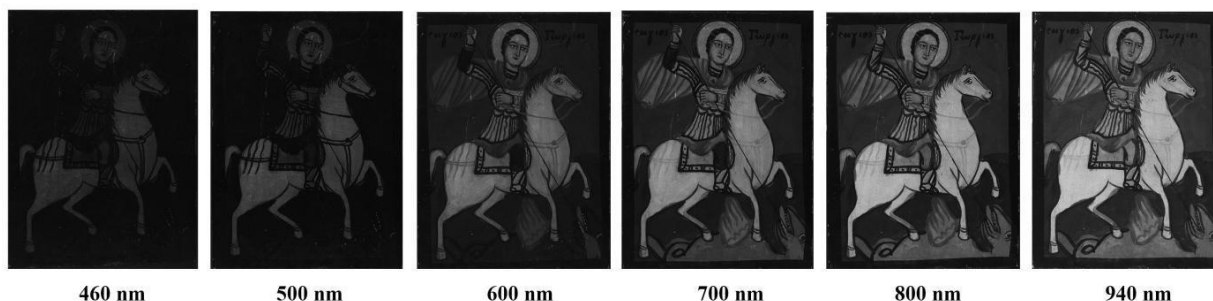
Εικόνα 61: Πολυφασματικές απεικονίσεις ανάκλασης της εικόνας Γ που λήφθηκαν με την MuSIS™ HS στις φασματικές ζώνες 460nm, 500nm, 600nm, 700nm, 800nm και 940nm.
