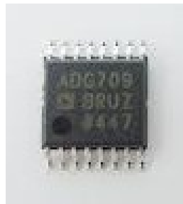
Σχήμα 27: Πολυπλέκτης (ADG709) high temperature, low voltage 8 channel multiplexer
