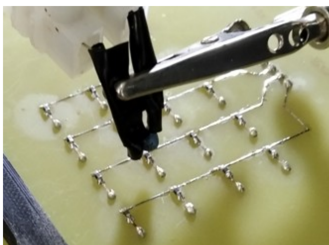
Σχήμα 71: Ο μικροθερμαντήρας κατά τη διάρκεια του πειράματος ευρισκόμενος πάνω από τον δισδιάστατο πίνακα αισθητήρα αφής
