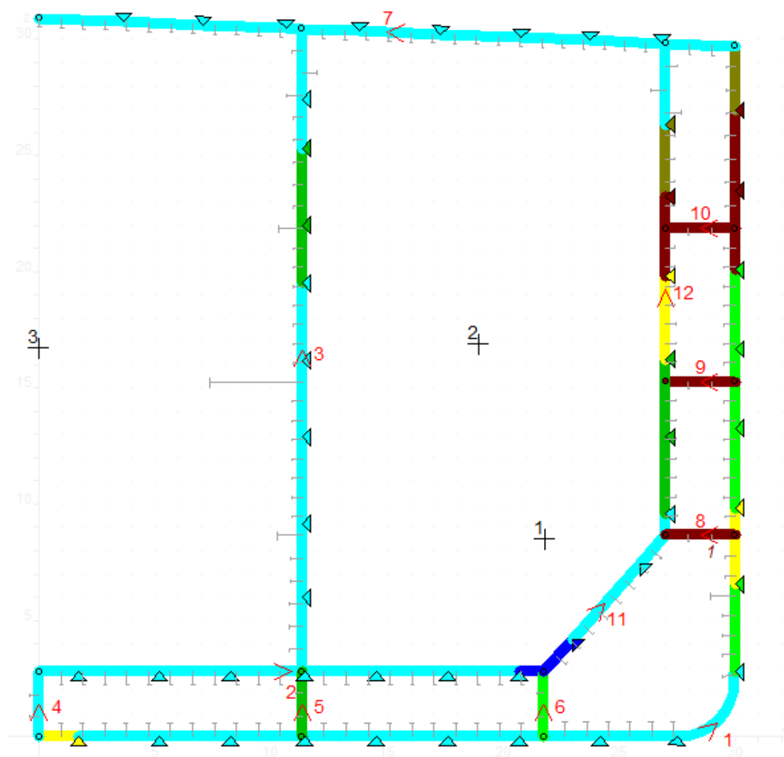
Εικόνα 62: Χρωματική απεικόνιση αποτελεσμάτων ελάχιστου πάχους ελάσματος
