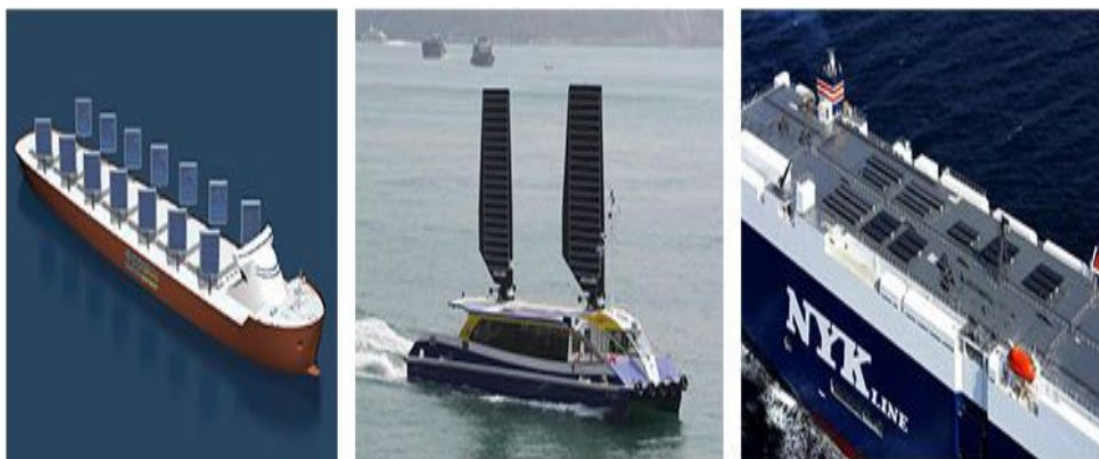
Εικόνα 4.7: Υβριδικά συστήματα με φωτοβολταϊκά. Από αριστερά προς τα δεξιά. 1) Aquarius MRE, 2) SolarSailor, 3) Augida Leader, Πηγή: [37]
