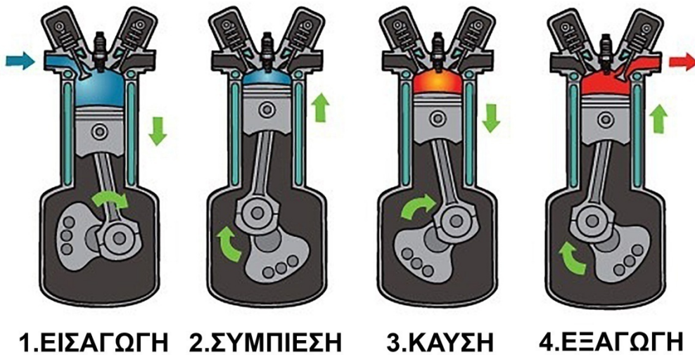
Εικόνα 1.1: Οι 4 χρόνοι ενός κινητήρα ΟΤΤΟ. Πηγή: [20]
