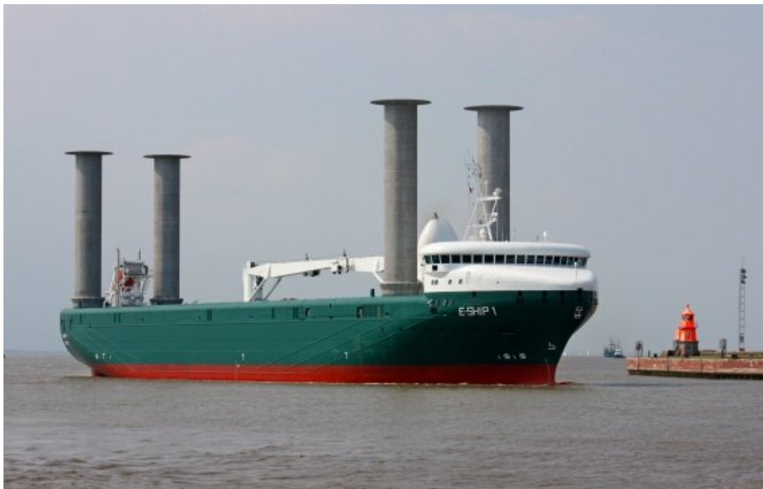
Εικόνα 4.13: Σχεδιασμός με ρότορες στο E-Ship 1. Πηγή: [42]
