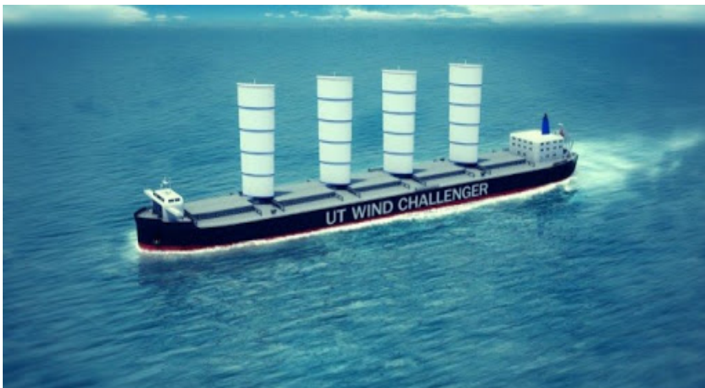
Εικόνα 4.10: Σχεδιασμός σταθερών πανιών στο UT Wind Challenger. Πηγή: [39]
