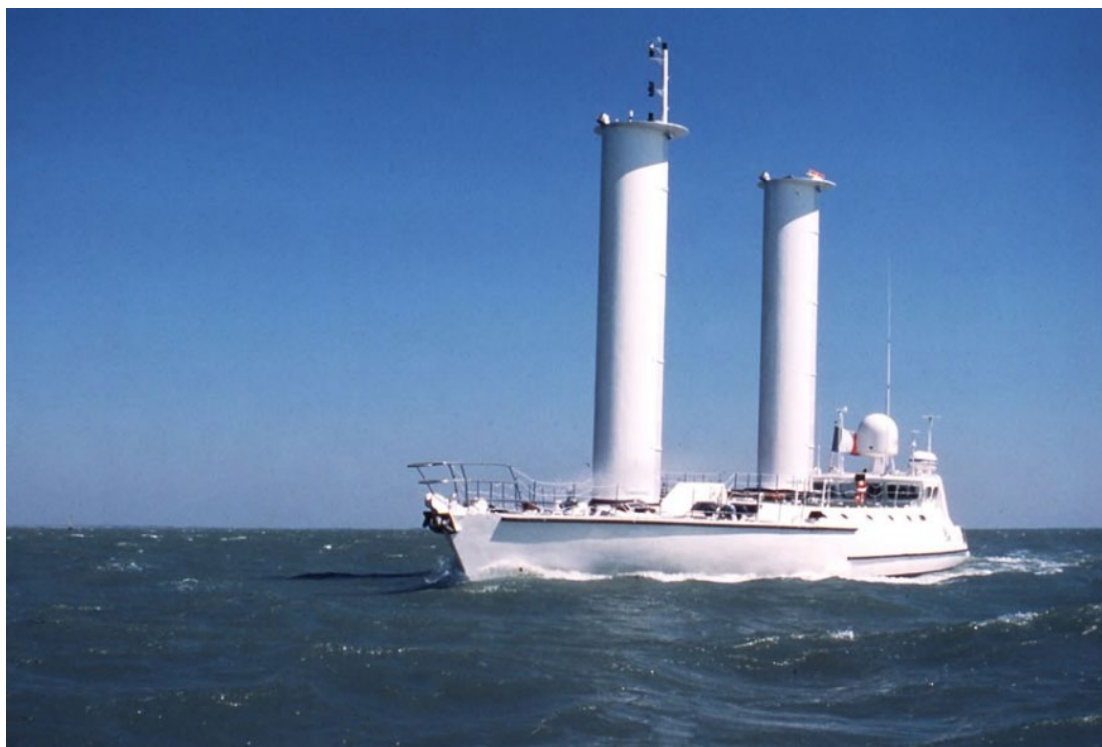
Εικόνα 4.12: Σχεδιασμός με ρότορες στο Alcyone. Πηγή: [42]
