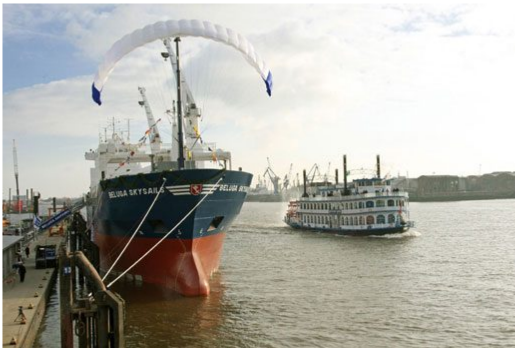
Εικόνα 4.14: Σχεδιασμός με χαρταετό στο Beluga Skysails.. Πηγή: [42]
