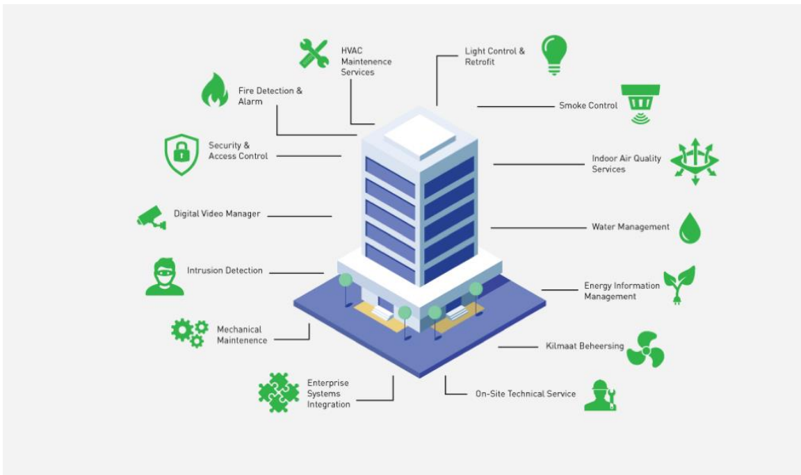
Εικόνα 3.2 Σημεία ελέγχου BMS
