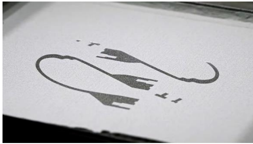
Εικόνα 2-6 Δημιουργία στρώματος μέσω τήξης σκόνης. Πηγή: (ALL3DP.com, 2022)
