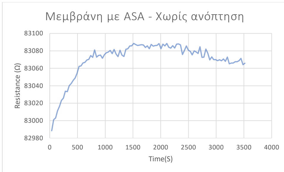
Εικόνα 4-11 Διάγραμμα αντίστασης - χρόνου για μεμβράνη ASA χωρίς ανόπτηση.
