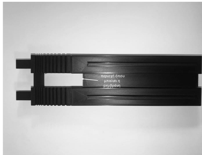
Εικόνα 3-18 Κάτοψη του πάνω τμήματος της δομής με βελάκι φαίνεται η περιοχή όπου τοποθετείται η μεμβράνη. Αρχειακό υλικό
