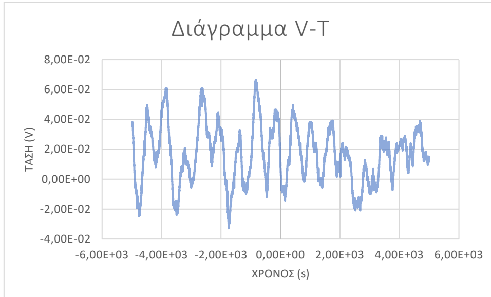
Εικόνα 3-46 Ενδεικτική κυματομορφή του σήματος εξόδου για τον συνδυασμό θέσεων (P0&P4) και ταχύτητα 24m/s.
