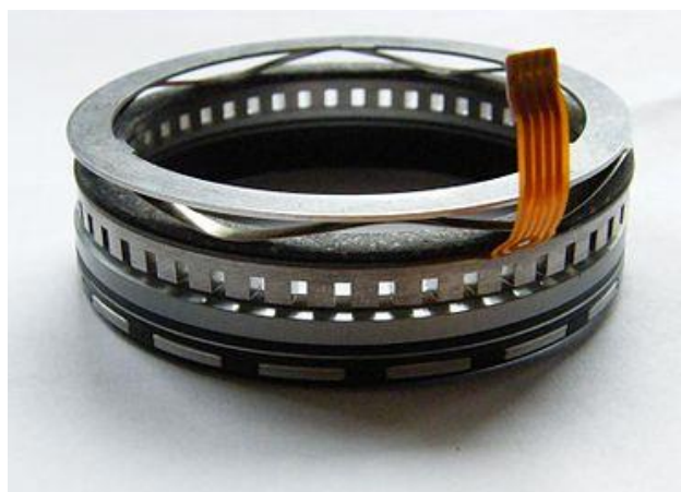
Εικόνα 1-9 Πιεζοηλεκτρικό κινητήρας που βασίζεται στην παραγωγή υπερήχων για την λειτουργία του. Πηγή: (en.wikipedia.org, 2008)
