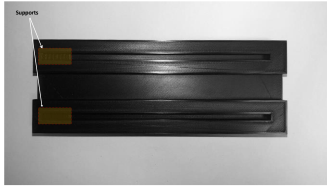
Εικόνα 3-19 Τμήμα από την δομή όπου διακρίνονται και οι βοηθητικές δομές "supports" της υποδοχής για να κουμπώσουν τα τμήματα μεταξύ τους. Αρχειακό υλικό
