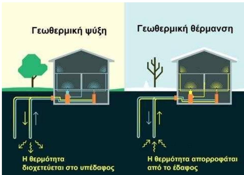
Εικόνα 8. Γεωθερμικά συστήματα ψύξης και θέρμανσης
