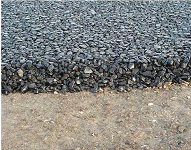
Εικόνα 22. Ανακυκλωμένα υλικά ασφάλτου.
