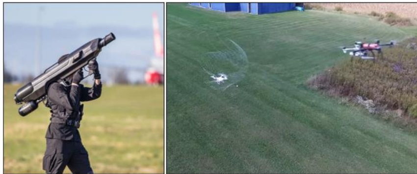
Εικόνα 27: (α) Συσκευή εκτόξευσης δικτυού, (β) Εκτόξευση δικτυού από drone [27]
