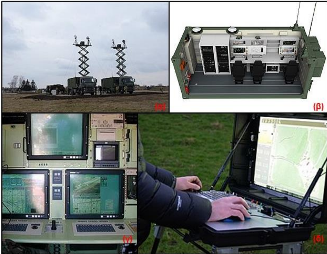
Εικόνα 14: (α) Σταθμοί Ελέγχου Εδάφους, (β) Εσωτερικό μέρος του GCS, (γ) Το "εικονικό" πιλοτήριο του GCS, (δ) GCS μικρής κλίμακας UAV [20]
