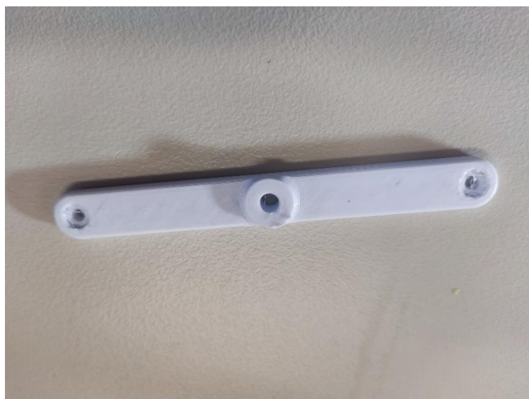
Εικόνα 4.6 Εκτύπωση συνδέσμου για κίνηση στο άξονα Y
