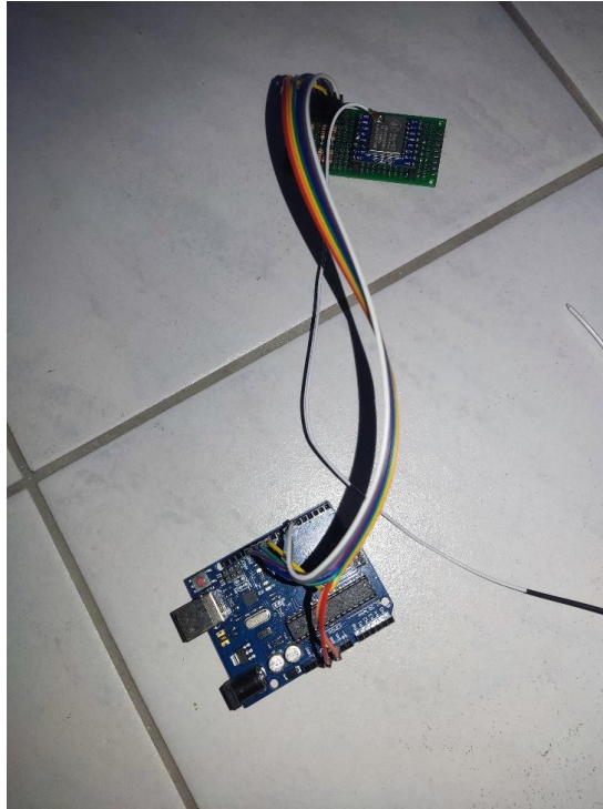
Εικόνα 3.14 Συνδεσμολογία SX1278 LoRa module με Arduino Uno
