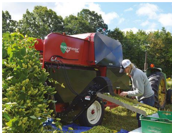
Εικόνα 110. Η μηχανή συγκομιδής HopsHarvester™ κατασκευασμένη στις Η.Π.Α έχει αναπτυχθεί για να εξυπηρετεί από μικρής έως μεσαίας κλίμακας αγρούς λυκίσκου (Dodds, 2017).
