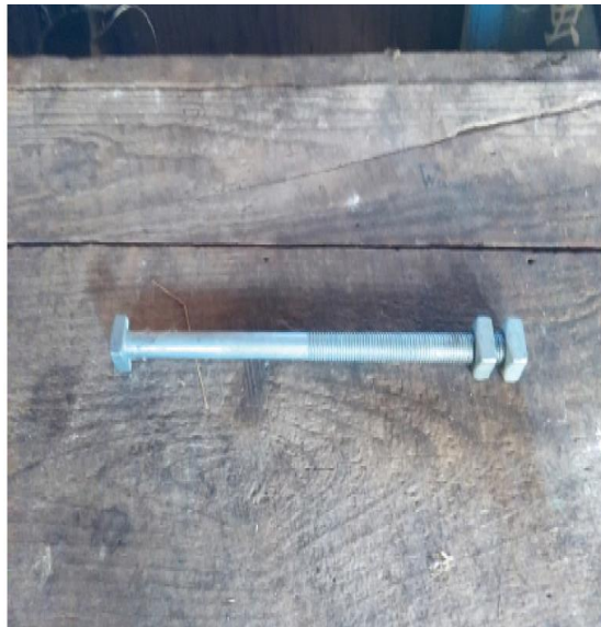
Εικόνα 40. Βίδες που ασφαλίζουν με παξιμάδια, συνδέουν τα εξαρτήματα του συρματόσχοινου με την κορυφή των στύλων (Eyck & Gehring, 2015).
