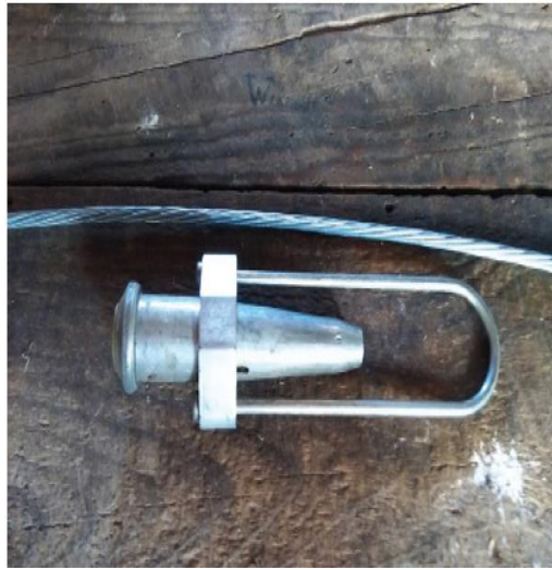
Εικόνα 36. Ο εντατήρας του ακραίου συρματόσχοινου συνδέει το ακραίο συρματόσχοινο με το άγκιστρο εδάφους (Eyck & Gehring, 2015).
