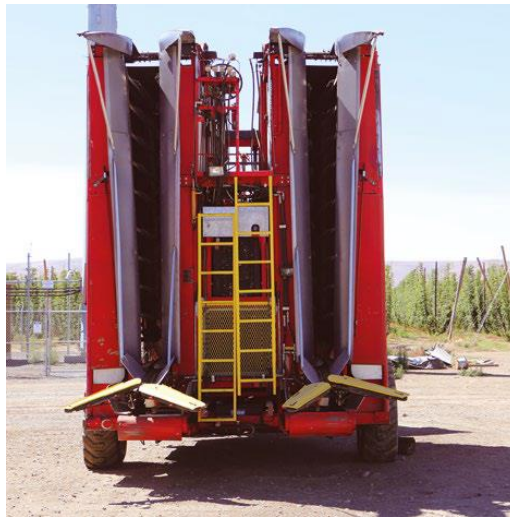
Εικόνα 104. Μπροστινή όψη μιας μηχανής συγκομιδής λυκίσκου στον αγρό, που χρησιμοποιείτε σε μεγάλης κλίμακας καλλιέργειας λυκίσκου με υποστύλωση τύπου «V», στις Η.Π.Α (Dodds, 2017).
