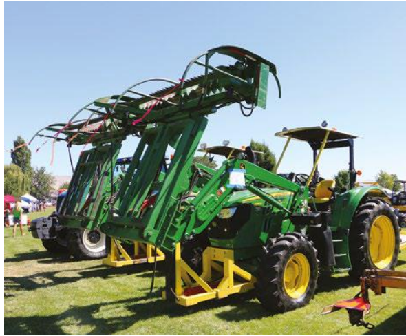
Εικόνα 106. Συνδυαστικού τύπου μηχανή, τα ψαλίδια κορυφής αποκόπτουν ολόκληρους τους βλαστούς από το συρματόσχοινο και τους ρίχνουν σε ένα φορητό για μεταφορά και συγκομιδή στην αποθήκη (Dodds, 2017).
