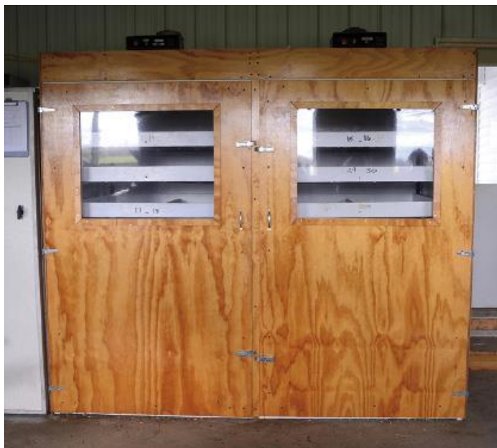
Εικόνα 120. Ο συναρμολογούμενος κλίβανος ξήρανσης σχεδιασμένος από το πανεπιστήμιο UVM έχει πολυάριθμα συρτάρια, δίνοντας την δυνατότητα ξήρανσης πολλαπλών ποικιλιών λυκίσκου ταυτόχρονα χωρίς να αναμιγνύονται. Τα σχέδια είναι διαθέσιμα στο διαδίκτυο (Eyck & Gehring, 2015).
