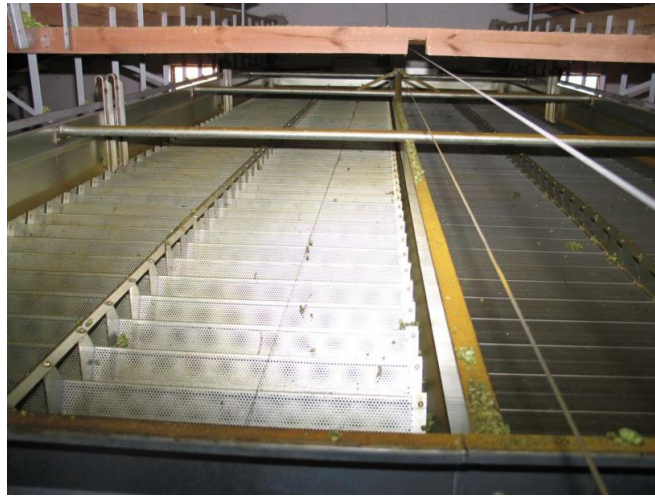
Εικόνα 117. Ανοιγμένο διάτρητο δάπεδο ξηραντήριου λυκίσκου (Barth & Sohn, 2016).
