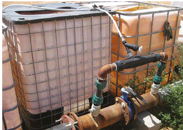
Εικόνα 73. Ένα βασικό σύστημα έγχυσης άρδευσης υδρολίπανσης (Dodds, 2017).
