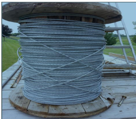
Εικόνα 31. Το συρματόσχοινο χρησιμοποιείται για να αγκιστρώνει τους ακραίους στύλους στο έδαφος. Επίσης διατρέχει κατά μήκος στις κορυφές των στύλων, διαμορφώνοντας το υψωμένο σύστημα υποστύλωσης που θα στηρίζει τους λυκίσκους (Eyck & Gehring, 2015).
