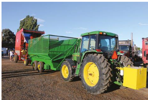
Εικόνα 105. Ένα τυπικό σύστημα συγκομιδής για καλλιέργεια μεγάλης έκτασης, η οποία περιλαμβάνει μηχανή συγκομιδής, αποθηκευτικό κάδο και ελκυστήρα (Dodds, 2017).
