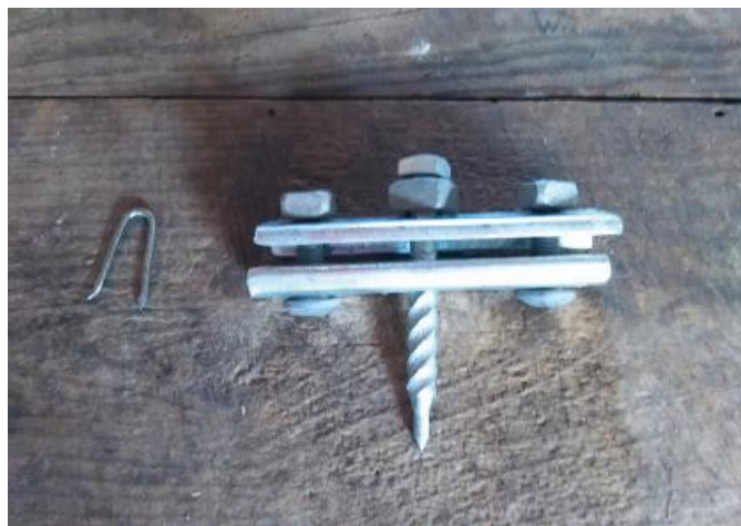
Εικόνα 43. Ο Σφικτήρας Δύο Βιδών και οι συνδετήρες ασφαλίζουν το συρματόσχοινο στην κορυφή των στύλων στο αγρό λυκίσκου (Eyck & Gehring, 2015).
