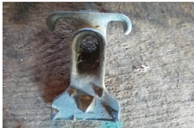
Εικόνα 39. Ο γάντζος συνδέει τον εντατήρα από το άγκιστρο εδάφους στην κορυφή του ακραίου στύλου (Eyck & Gehring, 2015).
