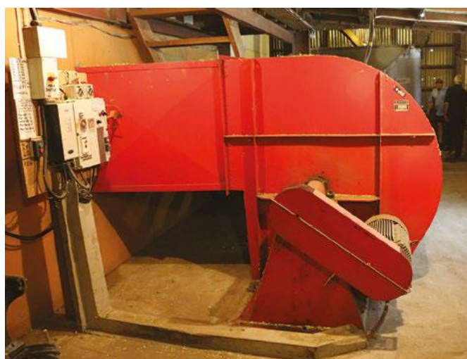
Εικόνα 116. Μεγάλου μεγέθους ανεμιστήρες ωθούν καθαρό θερμό αέρα μέσα στον θάλαμο κάτω από το ξηραντήριο. Η διάταξη του θαλάμου διασφαλίζει ομοιόμορφη διανομή αέρα και ξήρανση (Dodds, 2017).
