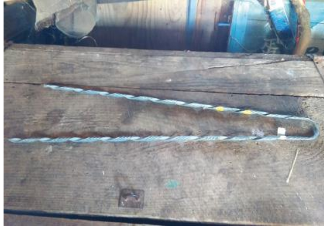
Εικόνα 41. Τα αδιέξοδα ασφαλίζουν το συρματόσχοινο και συνδέεται στα εξαρτήματα πάνω στο στύλο (Eyck & Gehring, 2015).
