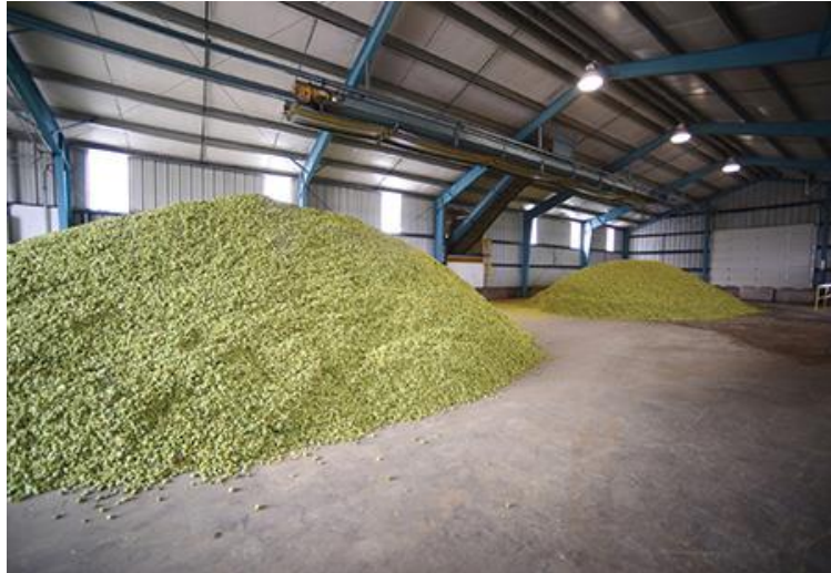
Εικόνα 119. Λυκίσκοι στοιβαγμένοι σε υψηλούς σωρούς στο έδαφος του χώρου εξισορρόπησης υγρασίας όπου τα επίπεδα της θερμοκρασίας και υγρασίας αφήνονται να εξισορροπηθούν για μια χρονική περίοδο είκοσι τεσσάρων ωρών (Eyck & Gehring, 2015).
