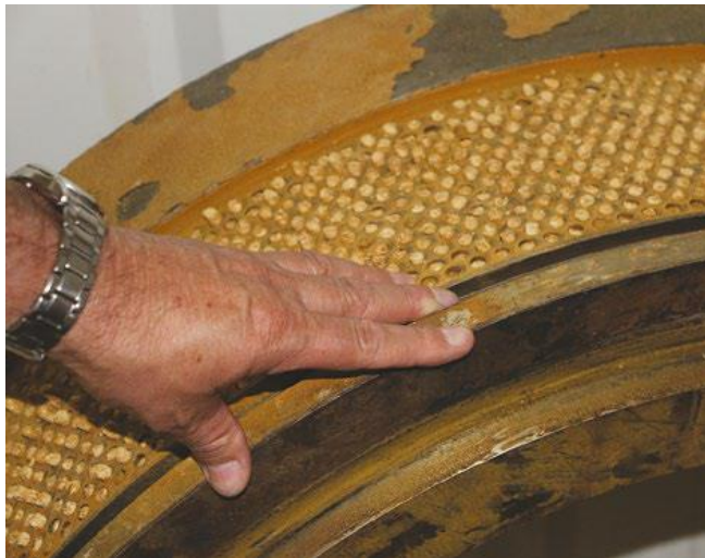
Εικόνα 123. Το εσωτερικό της κεφαλής μιας μηχανής σφαιροποίησης (Dodds, 2017).
