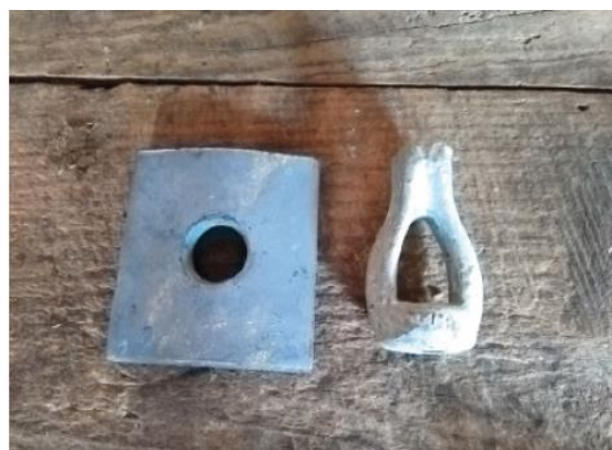
Εικόνα 42. Το παξιμάδι δακτυλήθρας οφθαλμού και η πλάκα συνδέει το συρματόσχοινο στην μεριά του ακραίου στύλου που βλέπει προς την μεριά του αγρού (Eyck & Gehring, 2015).
