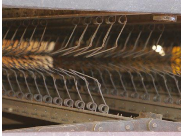
Εικόνα 109. Σειρές συρμάτινων δακτύλων μηχανής συγκομιδής λυκίσκου με ελατήριο, κινούμενα από αλυσίδες, τα οποία αποκόπτουν τους κώνους από τους βλαστούς (Dodds, 2017).
