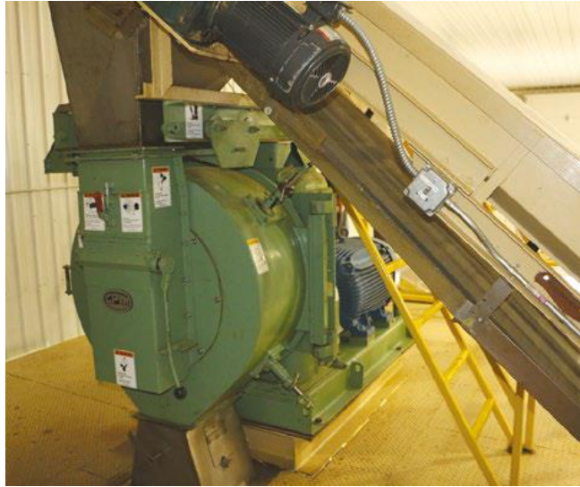
Εικόνα 122. Μία τυπική μηχανή σφαιροποίησης δακτυλίου τύπου T90 (Dodds, 2017).
