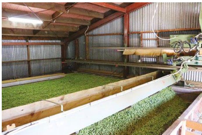
Εικόνα 115. Το άνω επίπεδο από ένα ξηραντήριο λυκίσκου με πολλά επίπεδα στην Νέα Ζηλανδία. Θερμασμένος αέρας αντλείτε μέσα από τα διάτρητα πατώματα στην κατάλληλη θερμοκρασία και ταχύτητα για να ξηράνει τους λυκίσκους σε επίπεδο περιεχόμενης υγρασίας 8 - 12% (Dodds, 2017).
