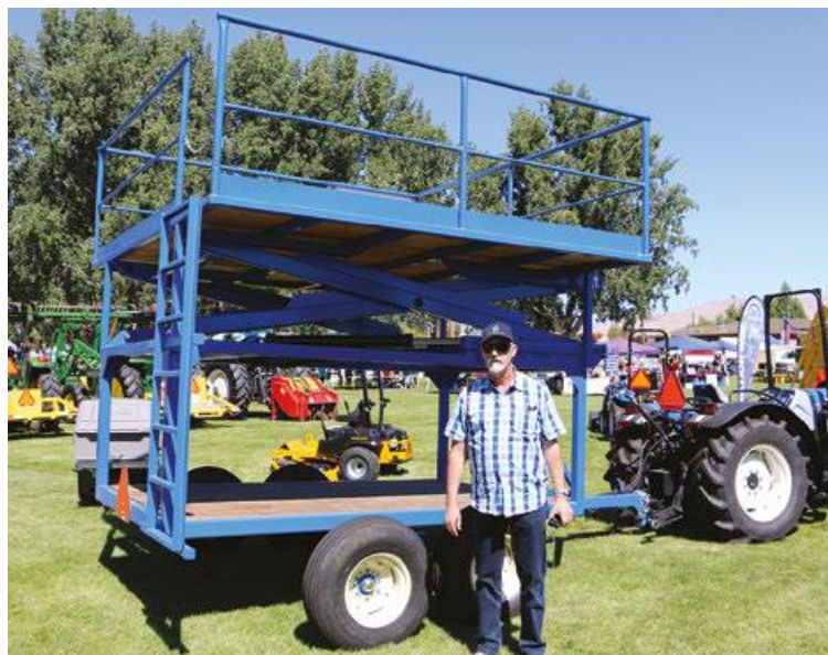
Εικόνα 85. Καλλιεργητές στις Η.Π.Α χρησιμοποιούν πλατφόρμες ρυμουλκόμενες από ελκυστήρες για να μειώσουν τα εργατικά κόστη κατά την διαδικασία τοποθέτησης σχοινιών (Dodds, 2017).
