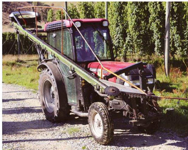
Εικόνα 107. Οι εξολκείς βλαστών χρησιμοποιούνται ως εναλλακτική των ψαλιδιών κορυφής σε μεσαίου μεγέθους καλλιέργειες λυκίσκου (Dodds, 2017).
