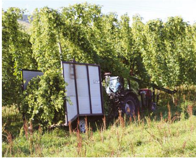
Εικόνα 108. Οι εξολκείς βλαστών δουλεύουν κατά μήκος μια μόνο σειράς βλαστών τη φορά απομακρύνοντας τους βλαστούς από το κορυφαίο συρματόσχοινο στον κάδο συγκομιδής για μεταφορά στην αποθήκη που βρίσκεται η μηχανή συγκομιδής (Dodds, 2017).
