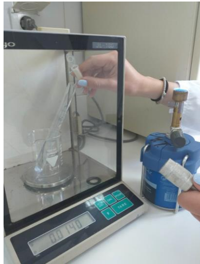
Εικόνα 21: Ζύγιση λυοφιλωμένης καλλιέργειας σε αναλυτικό ζυγό με τη χρήση λύχνου.
