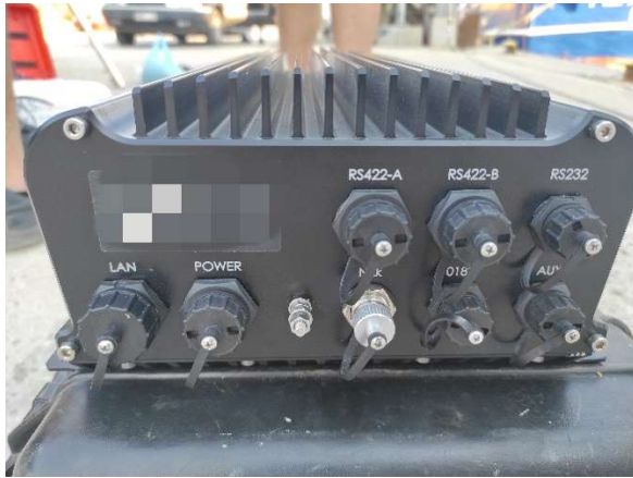
Εικόνα 5.2: Θύρες καλωδιακών απολήξεων
