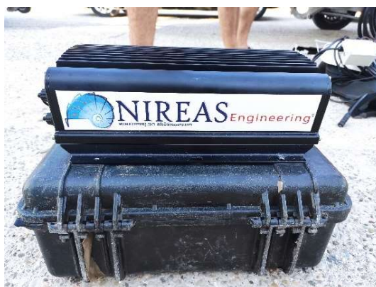
Εικόνα 5.1: Ηλεκτρονική μονάδα ηχοβολιστικού αισθητήρα
