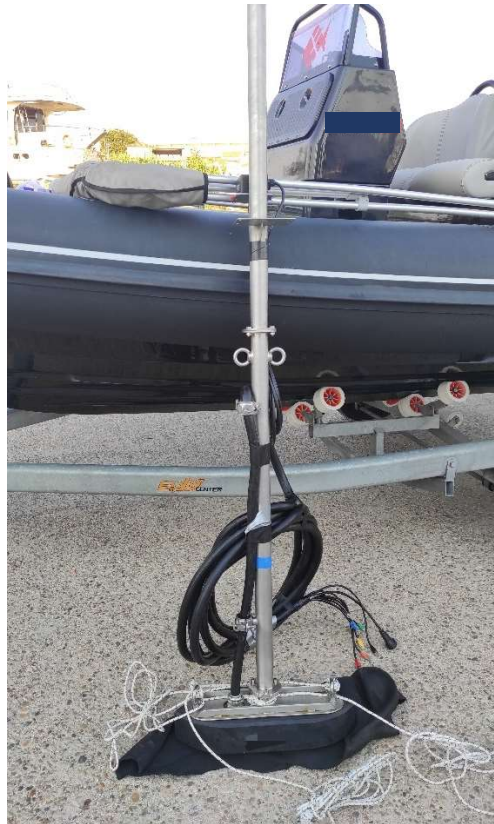
Εικόνα 5.2: Ανοξείδωτη μπάρα με εφαρμοσμένο στο ένα άκρο τον μορφοτροπέα (μάτι) του ηχοβολιστικού.
