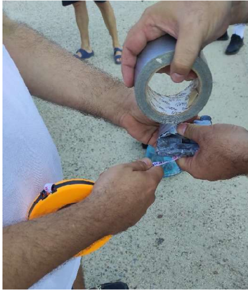
Εικόνα 5.13: Προσκόλληση βαριδιού σε μετροταινία, για δημιουργία τεχνητού σκαντάγιου
