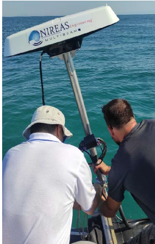
Εικόνα 6.3: Τοποθέτηση ανοξείδωτης μπάρας στην αριστερή πλευρά του σκάφους
