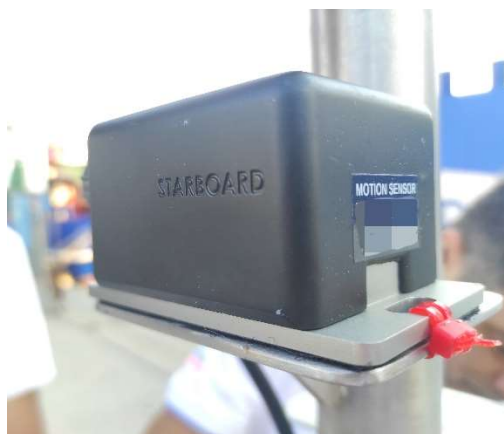
Εικόνα 5.5: Αισθητήρας κίνησης τοποθετημένος σε ανοξείδωτη μπάρα.
