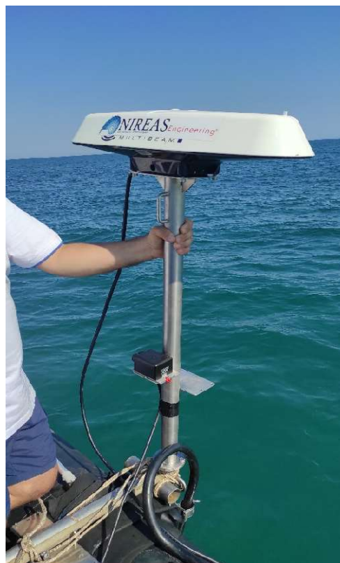
Εικόνα 6.4: Τοποθέτηση ανοξείδωτης μπάρας και πρόσδεση με σκοινιά
