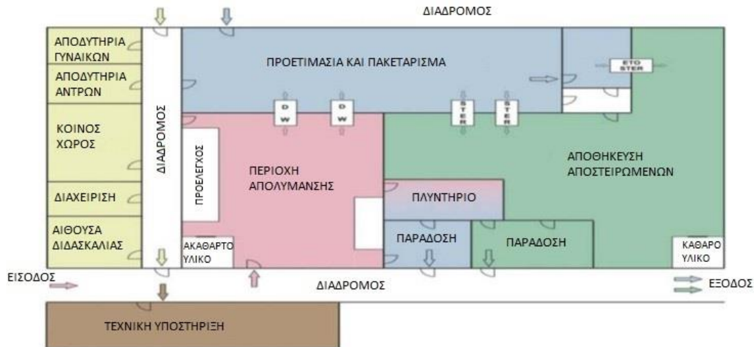
Εικόνα 1. Διάταξη τμήματος αποστείρωσης. (πηγή: Organization, W. 2016)
