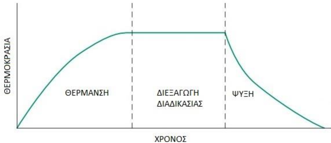
Εικόνα 3. Θερμοκρασία σε συνάρτηση με το χρόνο λειτουργίας του κλιβάνου αποστείρωσης ατμού (πηγή: Sibyl Preston 2019)
