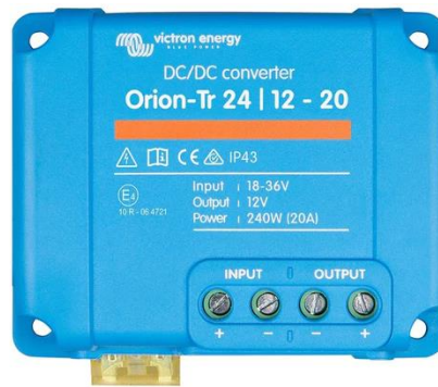
Εικόνα 5-13 Ο μετατροπέας DC/DC για την τροφοδότηση των 12βολτων συσκευών ( frenchman-energy.eu )
