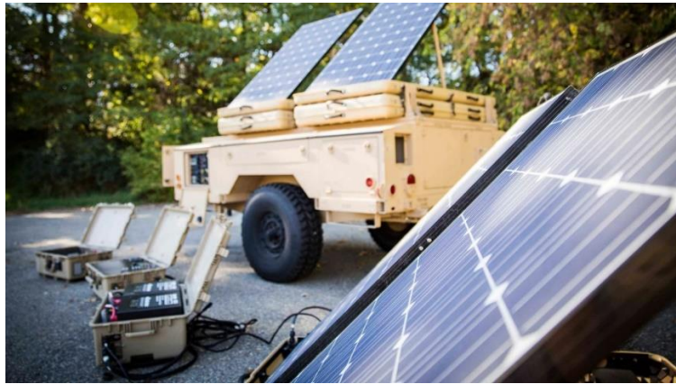
Εικόνα 2-9 Φωτοβολταϊκά συστήματα ισχύος του στρατού των ΗΠΑ, τοποθετημένα σε ρυμουλκούμενα της σειράς T, για πολεμικές επιχειρήσεις SimpliPhi Power
