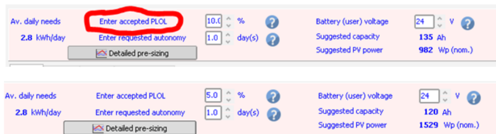
Εικόνα 6-5 Επίδραση του ποσοστού Loss Of Load στα χαρακτηριστικά των πάνελ
