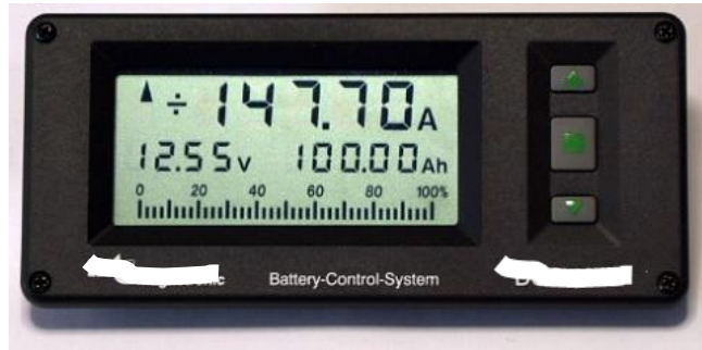
Εικόνα 5-4 Η οθόνη του συστήματος εποπτείας των μπαταριών
