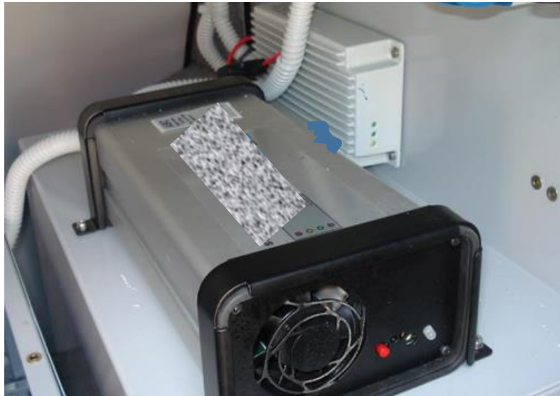
Εικόνα 5-5 Σε πρώτο πλάνο ο φορτιστής των 24V και πίσω του με λευκό χρώμα ο φορτιστής των 12V
