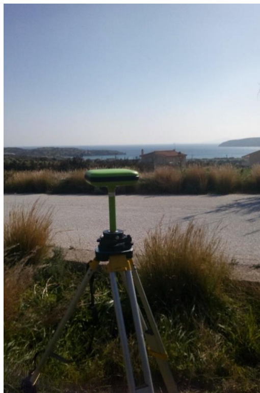
Εικόνα 5.7 Τοποθέτηση δέκτη GNSS στη στάση ΣΤ2.
