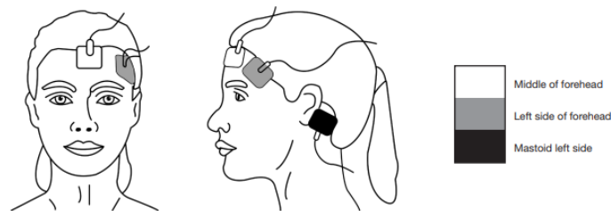
Εικόνα 74: Τοποθέτηση ηλεκτροδίων για την παρακολούθηση της εγκεφαλικής κατάστασης CSM [ Patient Monitor Multi-Parameter UP-7000 (2022). User Manual. Revision 6-05. Gima. Accessed: JAN. 25, 2023. Available: https://www.gimaitaly.com/DocumentiGIMA/Manuali/EN/M35145EN.pdf ]
