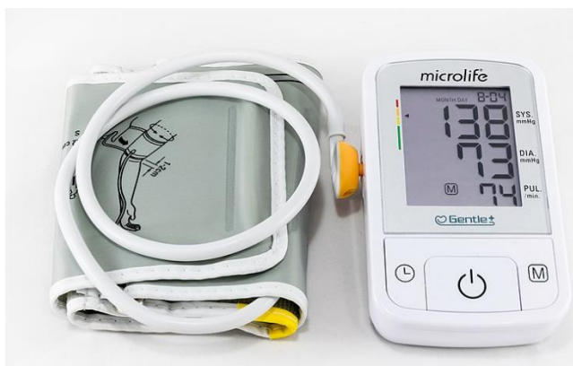
Εικόνα 42: Ταλαντωμετρικό – παλμομετρικό πιεσόμετρο (ηλεκτρονικό) [ https://commons.wikimedia.org/wiki/File:2020_Sfigmomanometr_elektroniczny.jpg ]
