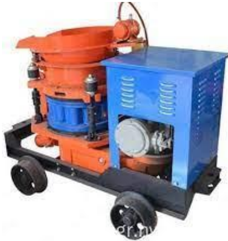
Εικόνα 54 Σύγχρονη μηχανή παρασκευής ινοπλισμένου εκτοξευόμενου σκυροδέματος
