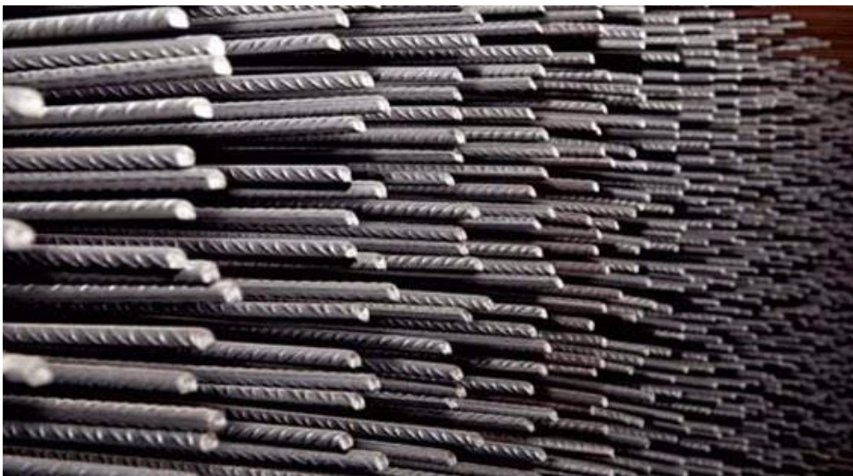
Εικόνα 15 Χαλύβδινες βέργες οπλισμού
