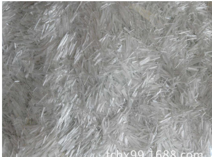
Εικόνα 34 Ίνες γυαλιού αλκαλικής αντίστασης, υψηλής ποιότητας
