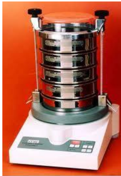
Εικόνα 9 Διαδικασία κοκκομετρικής ανάλυσης με κόσκινα
