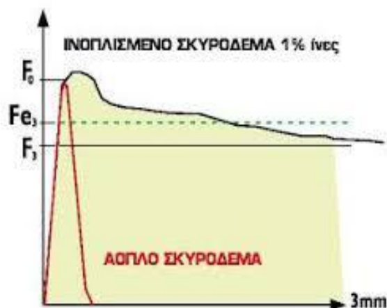
Εικόνα 26 Καμπύλη φορτίου-παραμόρφωσης για ινοπλισμένο και άοπλο σκυρόδεμα
