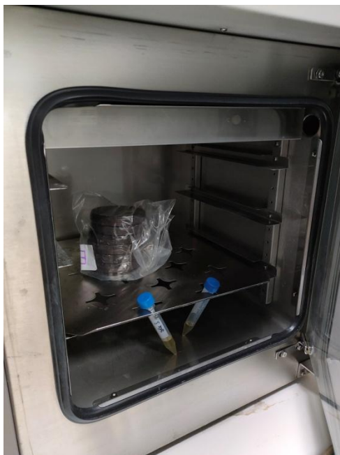
Εικόνα 3.9: Επώαση των τρυβλίων στον κλίβανο σε θερμοκρασία 37°C και 5% CO 2 .
