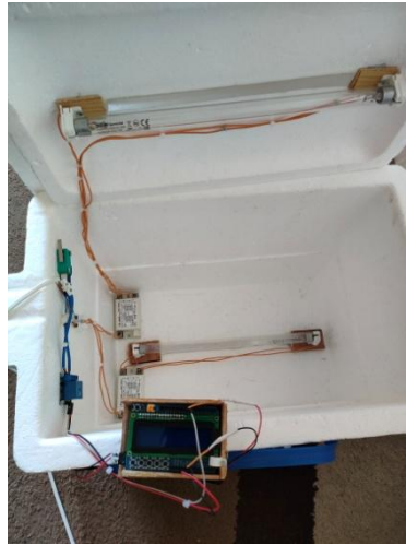
Εικόνα 2.15: Τοποθέτηση Λαμπτήρων και διάταξης Ρελέ.
