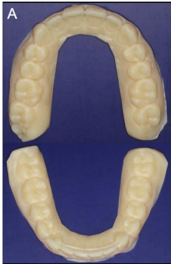
Εικόνα 38. Εκμαγεία εκτυπωμένα με τεχνολογία MJ. 54
