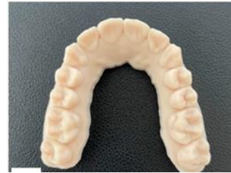
Εικόνα 26. Εκμαγείο εκτυπωμένο με DLP τεχνολογία. 74
