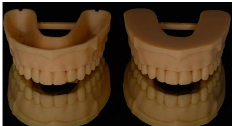
Εικόνα 24. Εκμαγεία εκτυπωμένα με τεχνολογία DLP. 49
