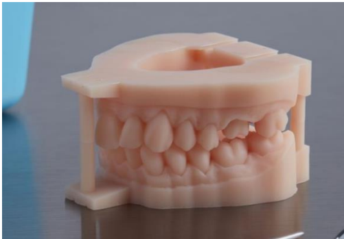
Εικόνα 34. Εκμαγεία εκτυπωμένα με SLS τεχνολογία. 87
