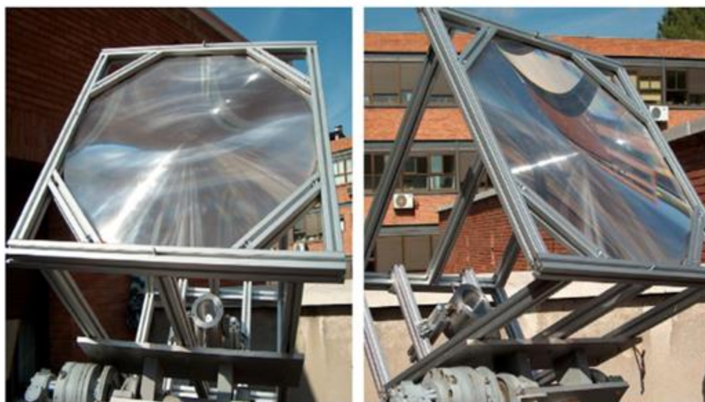
Εικόνα 42. Εγκατάσταση φακού Fresnel για φωτοβολταϊκή χρήση
