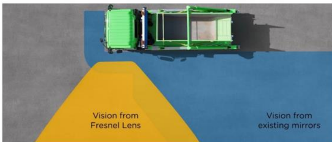
Εικόνα 39. Οπτικό πεδίο φακού Fresnel σε σύγκριση με παραδοσιακούς καθρέπτες
