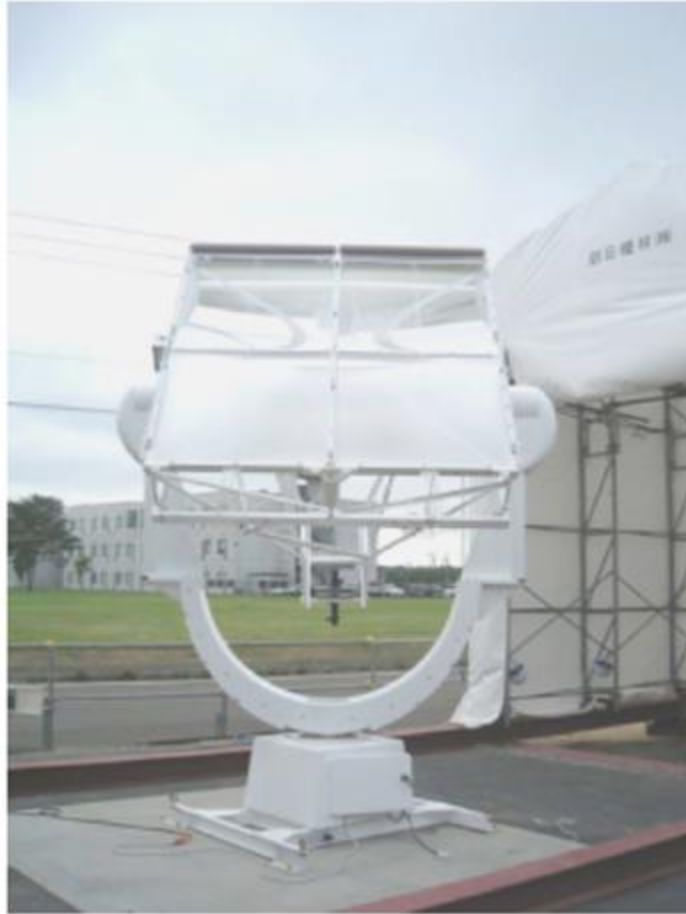
Εικόνα 43. Ρύθμιση λέιζερ με ηλιακή άντληση με χρήση φακών Fresnel
