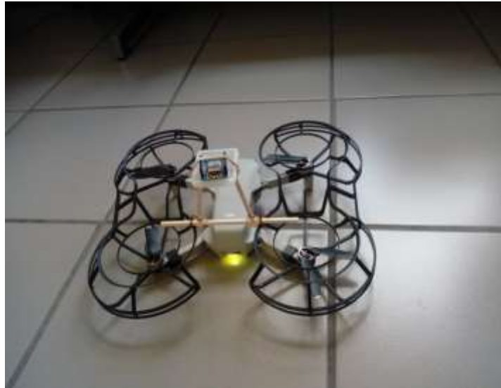
Εικόνα 2.13 - Drone περιστρεφόμενων στροφείων με αισθητήρα που χρησιμοποιήθηκε για την λήψη των μετρήσεων
