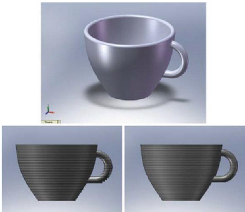
Εικόνα 1. Μοντέλο CAD κούπας και ακρίβεια αντικειμένου βάσει διαφορετικού πάχους στρώματος [1]
