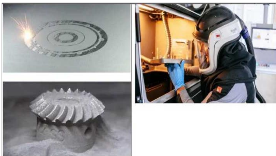
Εικόνα 7. Συσσωμάτωση με Λείζερ πούδρας μετάλλου (DMLS). [3]
