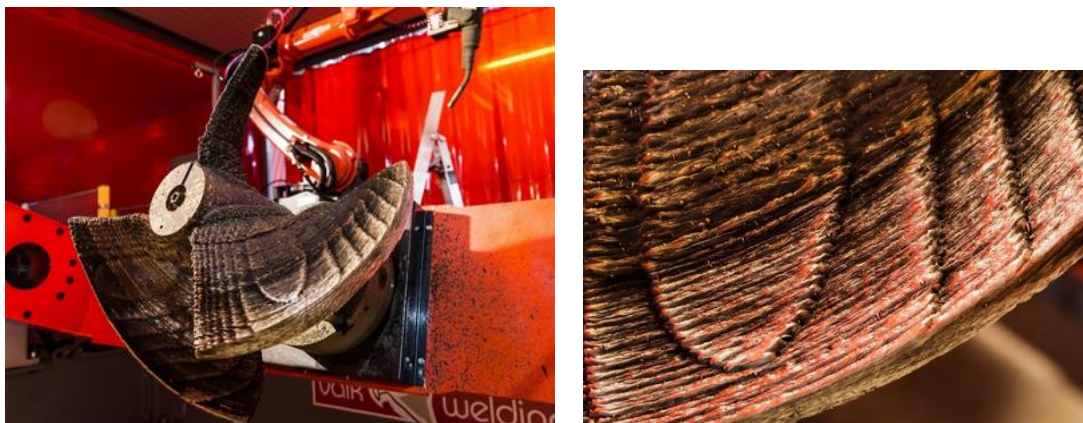
Εικόνα 12. Κατασκευή προπέλας με τεχνολογία τρισδιάστατης εκτύπωσης [7]
