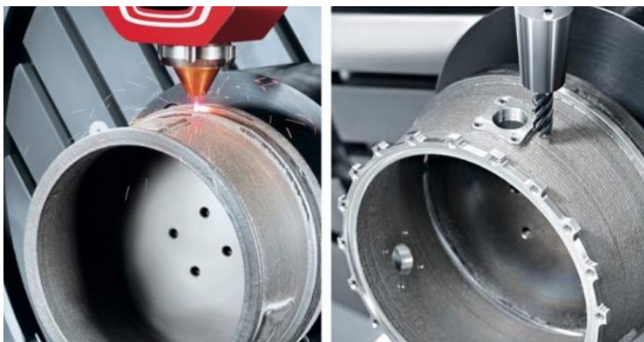
Εικόνα 11. Κατευθυνόμενη Εναπόθεση Ενέργειας (αριστερά) και κατεργασία CNC (δεξιά) σε υβριδικό κέντρο κατεργασίας DMG MORI [6]
