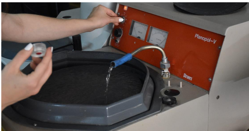
Εικόνα 10: Στίλβωση επιφάνειας εγκιβωτισμένων δειγμάτων.
