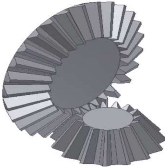
Σχήμα 1.3: 3-D μοντέλο ζεύγους κωνικών οδοντωτών τροχών με ευθείς οδόντες
