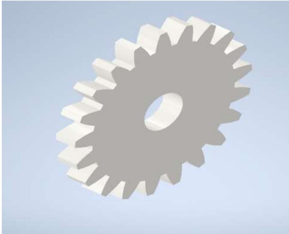
Σχήμα 4.3: 3-D μοντέλο τροχού 21 οδόντων με σπή
