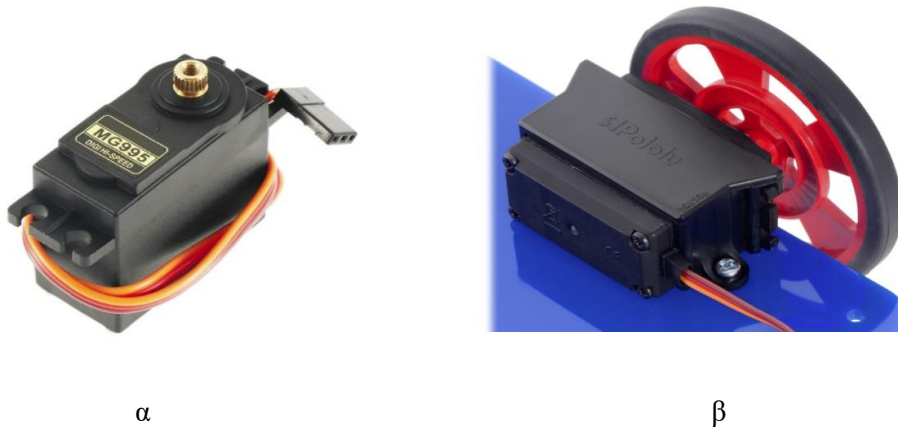
Εικόνα 2-10: Στην εικόνα 7.α. απεικονίζεται ένας τυπικός σερβοκινητήρας και στην 7.β. είναι το στηρίγμα σύμφωνα με το σχεδιάστηκε η κάτω πλάκα σε αυτή την περίπτωση
